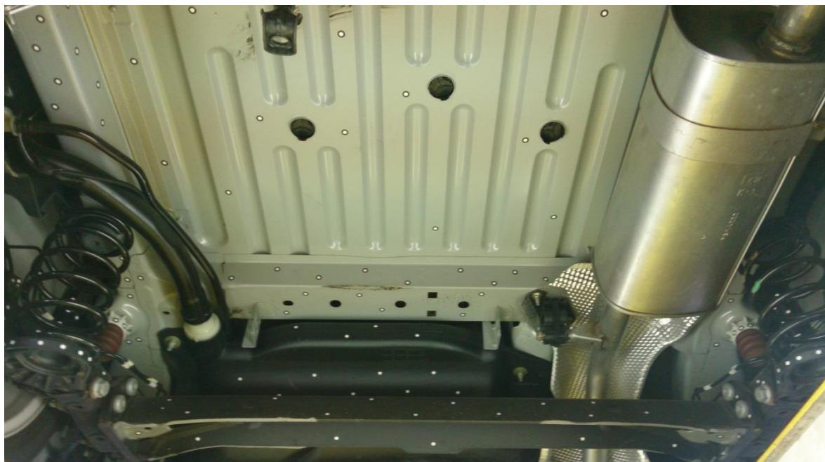
Slika 3.3 Prostor za ugradnju električnog pogona
