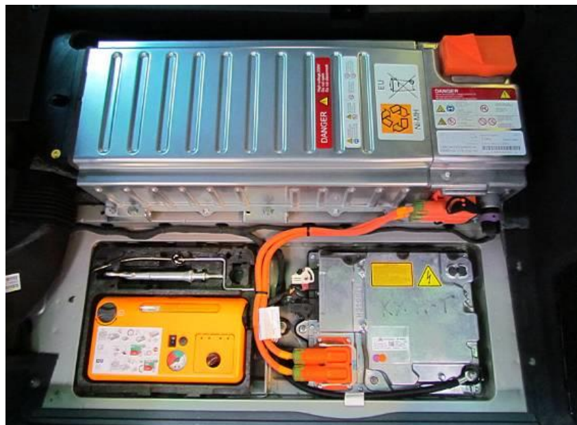
Slika 2.13 Smještaj računala hibridnog sklopa u prtljažniku vozila[3]
