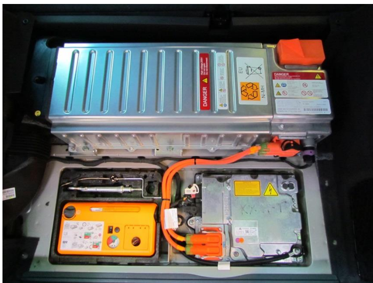
Slika 2.6 Smještaj baterijskog paketa u prtljažniku vozila [3]
