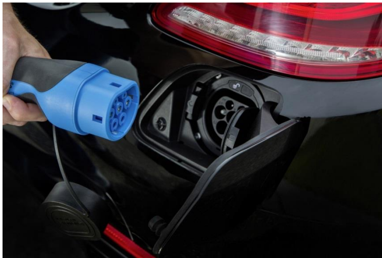
Slika 1.4 Priključak za punjenje električne energije standarda IEC 62196 [11]
