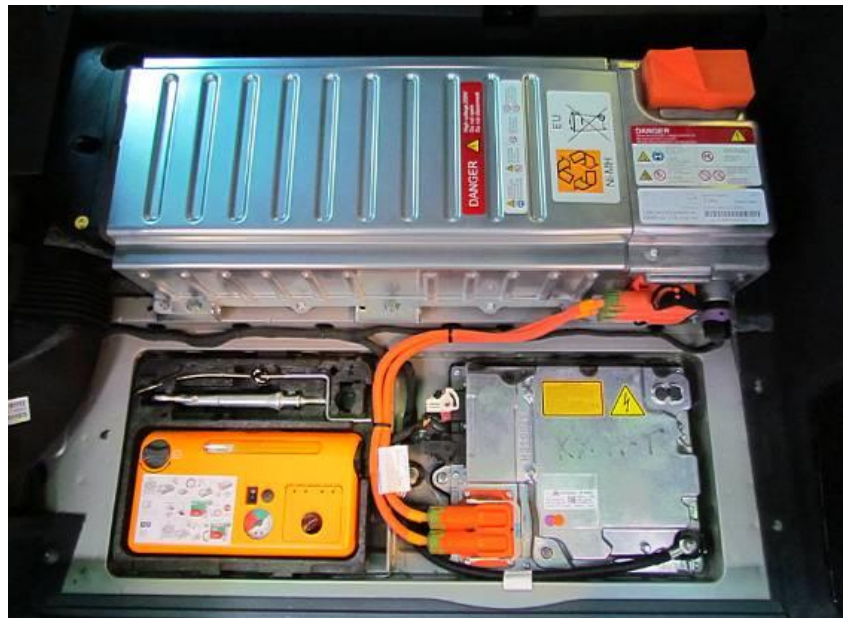
Slika 2.13 Smještaj računala hibridnog sklopa u prtljažniku vozila[3]
