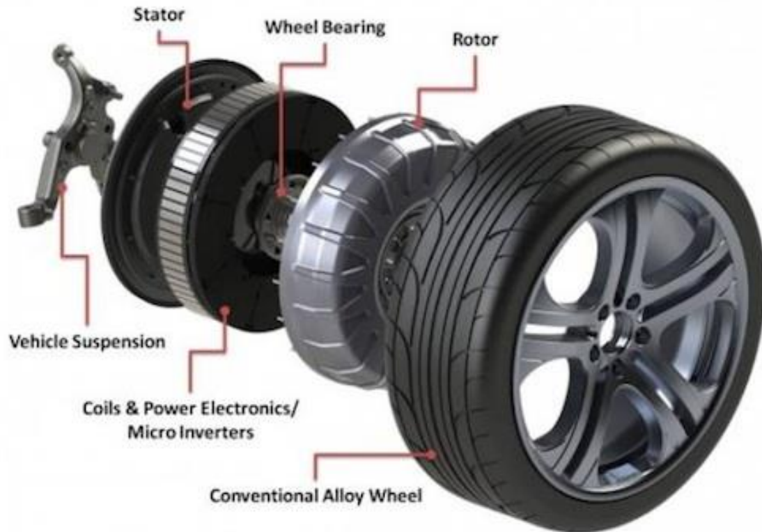
Slika 2.16 Komponente elektromotora u kotaču tvrtke Brabus [13]
