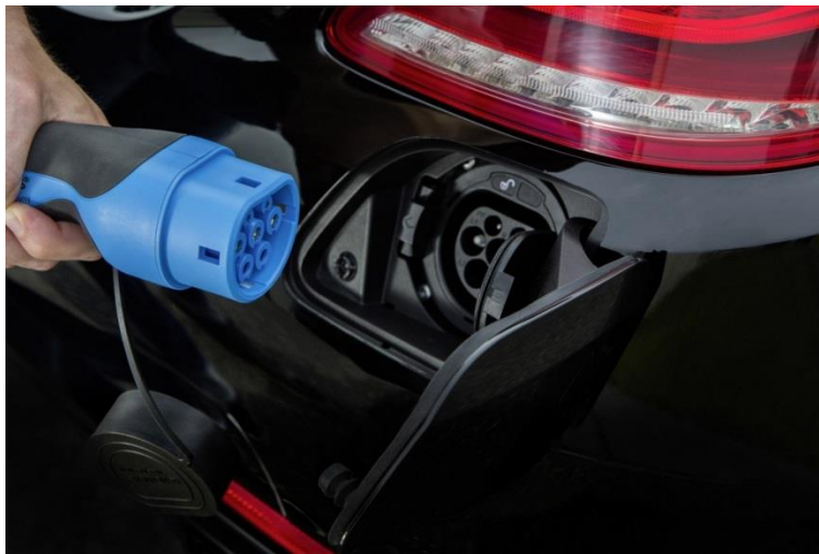
Slika 1.4 Priključak za punjenje električne energije standarda IEC 62196 [11]
