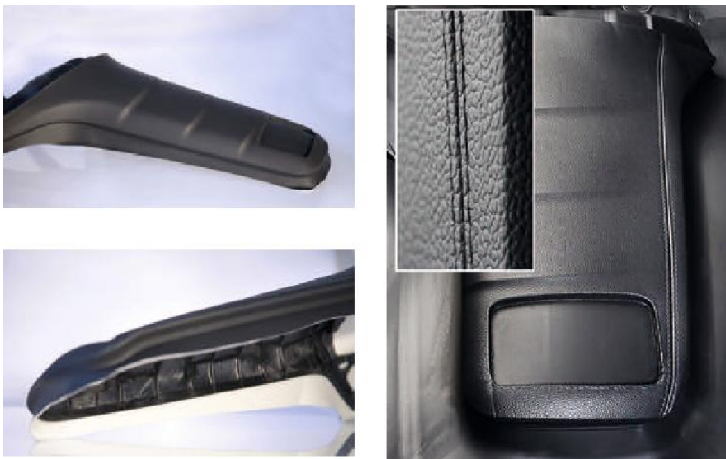
Slika 4.22 Upravljačka ploča proizvedena postupkom Varysoft [30]
