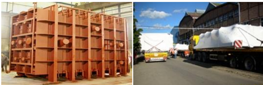
Slika 9. Vakuumska peć i transport vakuumske peći [11]
