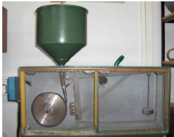
Slika 5.4. Uređaj za ispitivanje metodom „suhi pijesak/gumeni kotač“ [13]
