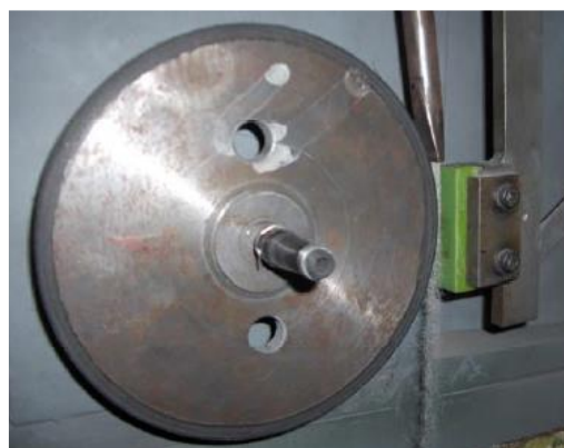
Slika 5.5. Detalj uređaja: kotač, gumena traka, mlaznica, pijesak, držač uzorka [13]
