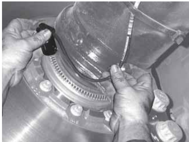
Slika 53. Senzor brzine vrtnje kotača
