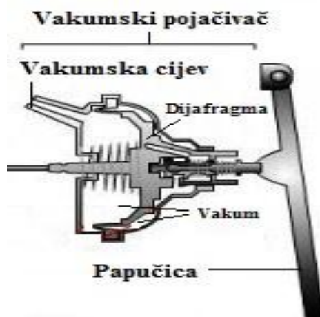
Slika 7. Vakuumski pojačivač sile kočenja
