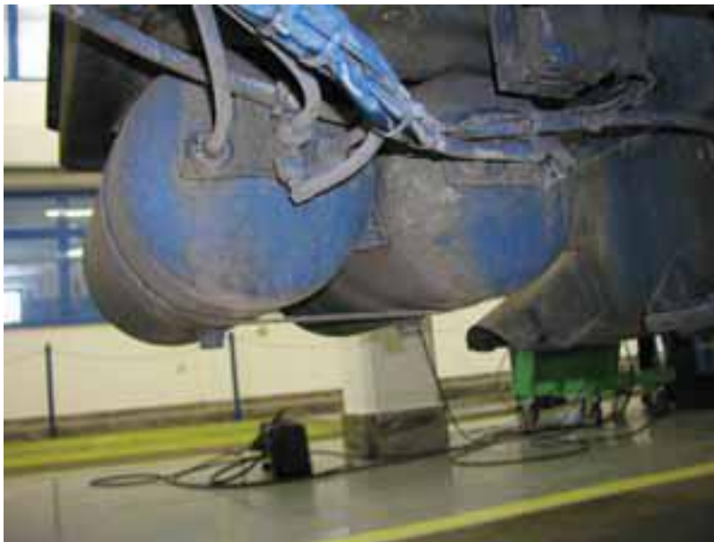
Slika 47. Spremnici zraka s ručnim ventilom za ispuštanje kondezata
