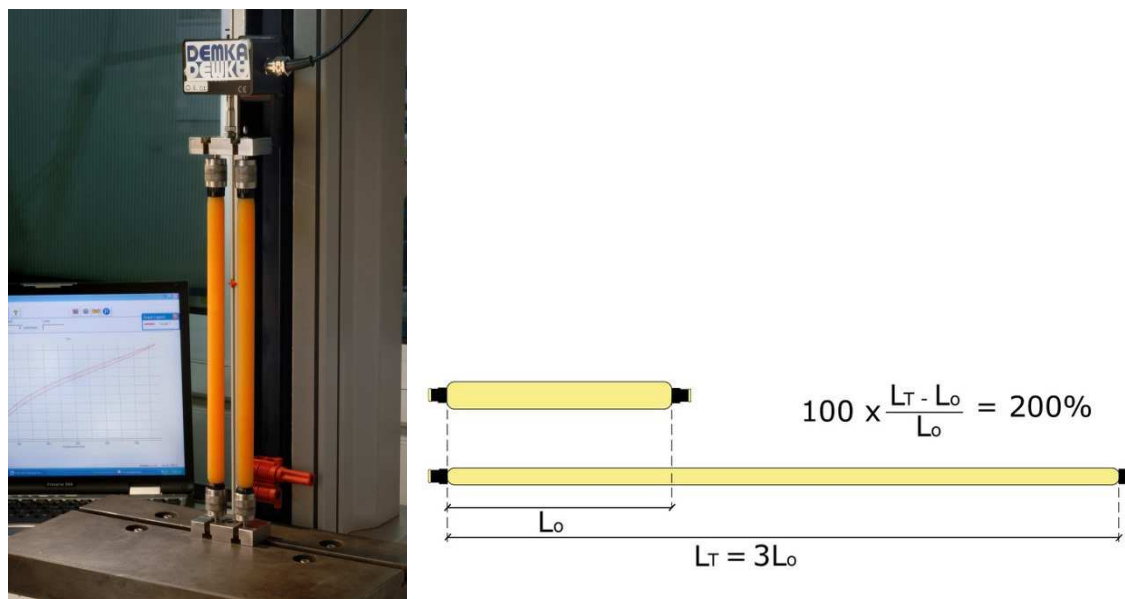
Slika 29. Ispitivanje snage rastezanja u Demka laboratoriju
