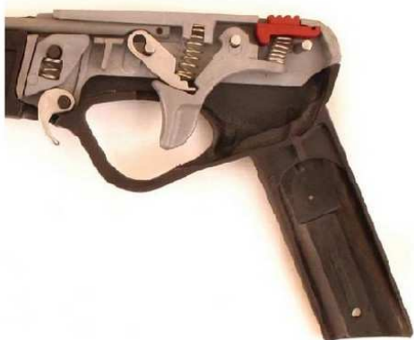
Slika 9 . Članovi mehanizma unutar polimernog kućišta Picasso puške.
