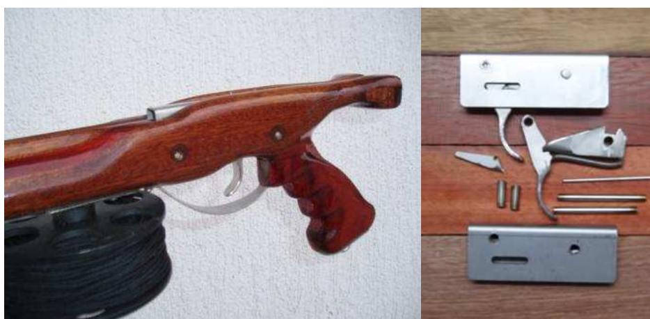
Slika 8. Drveno tijelo puške sa pripadajućim metalnim kućištem
