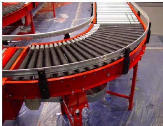
Slika 11. Zakrivljeni valjčani konvejeri [2]
