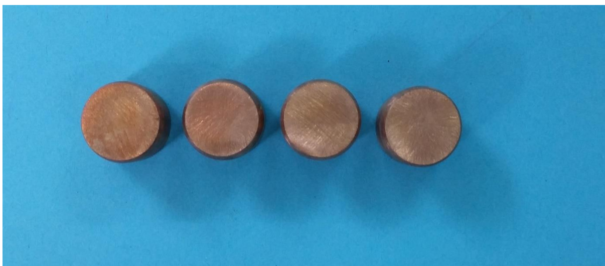
Slika 42. Rezultati VIA testa uzoraka od bakra ispitivanih PE folijom debljine 200 \mu\text{m}
