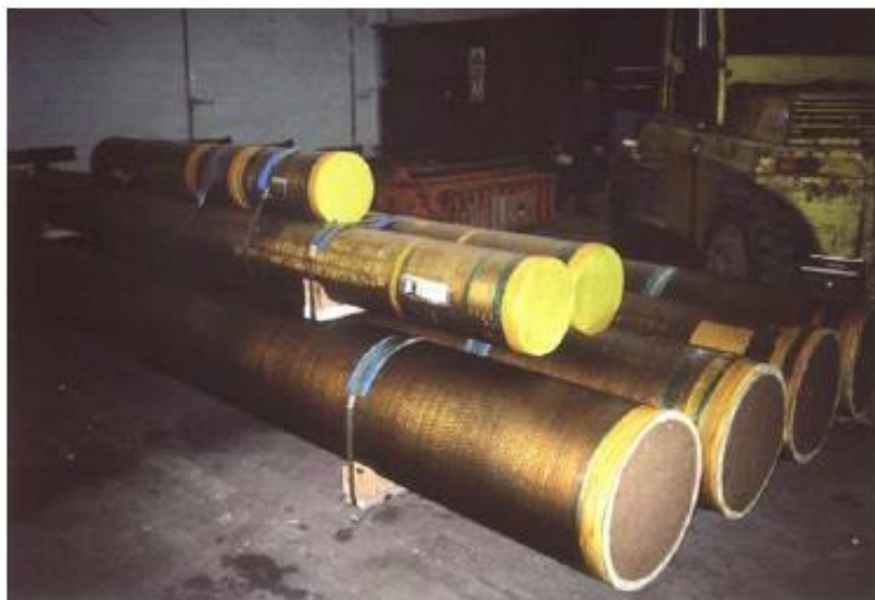
Slika 12. Privremena zaštita unutrašnjosti cijevi praškastim inhibitorima korozije [12]
