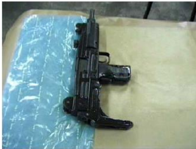
Slika 14. Primjena inhibitora korozije za zaštitu pješačkog naoružanja [12]
