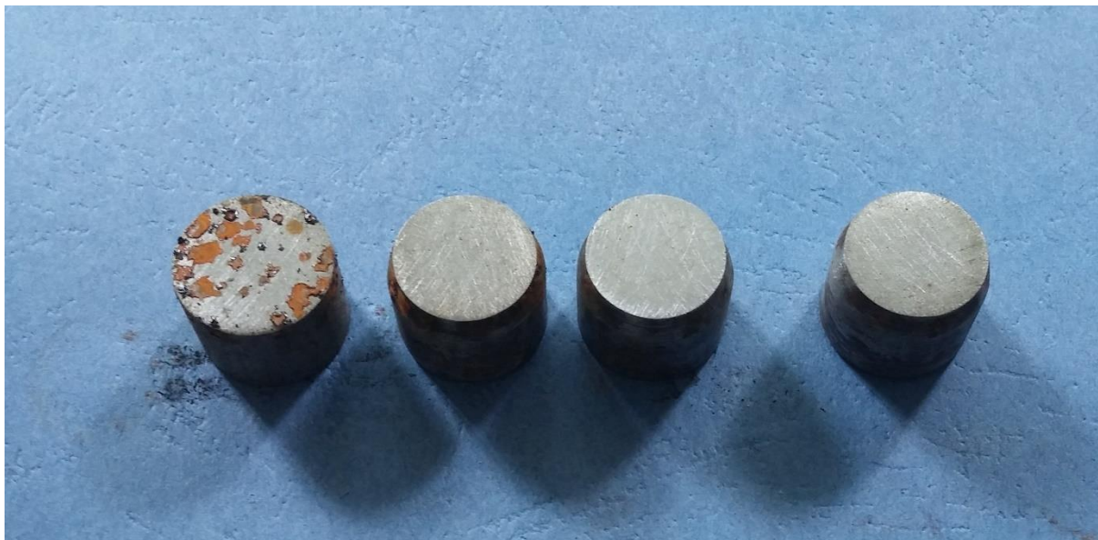
Slika 41. Rezultati VIA testa uzoraka od ugljičnog čelika ispitivanih PE folijom debljine 200 \mu\text{m}
