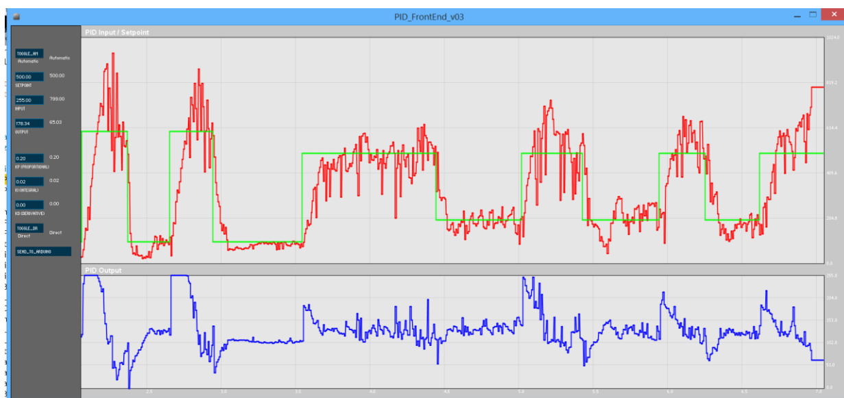
Slika 27. Regulacija pneumatskog sustava, eksperimentalni odziv K_p=1 , K_i=0.5 , K_d=0 .
