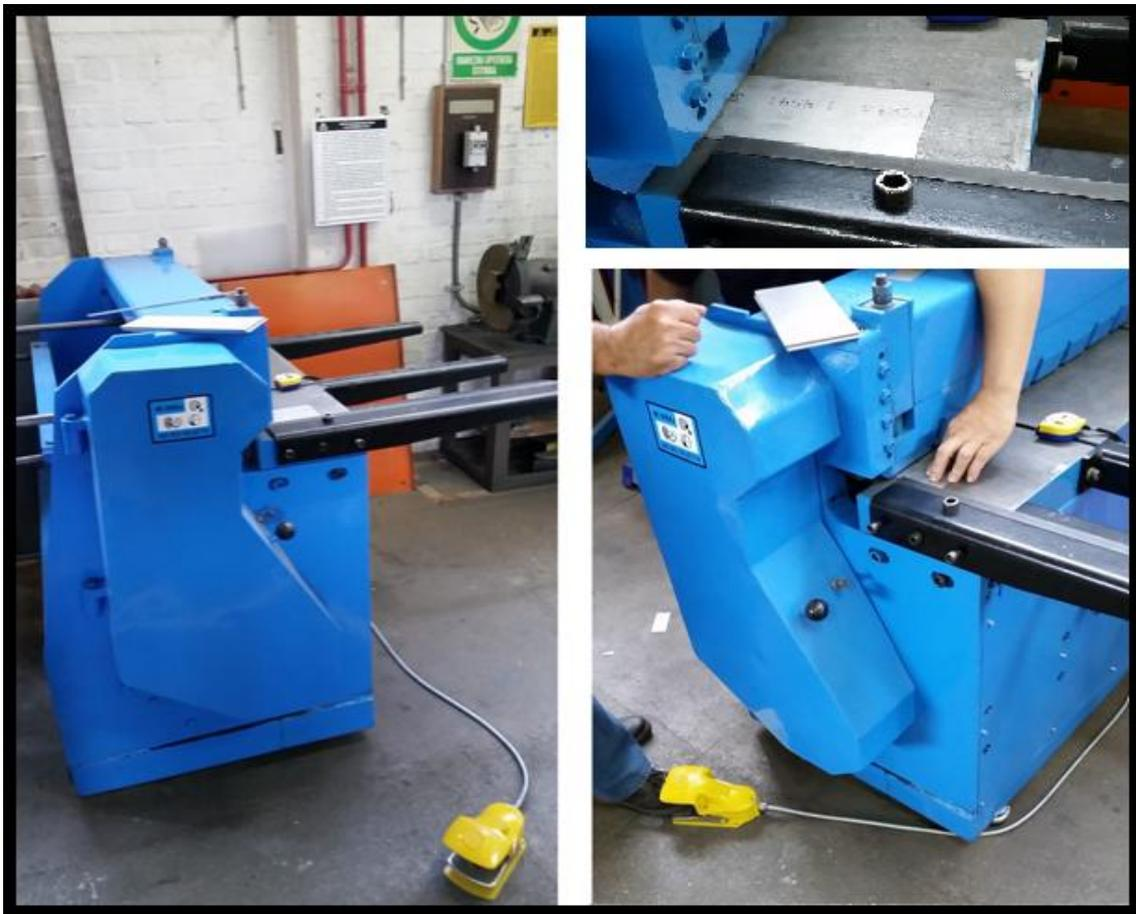
**Slika 28.** Rezanje ispitnih uzoraka na strojnim škarama
