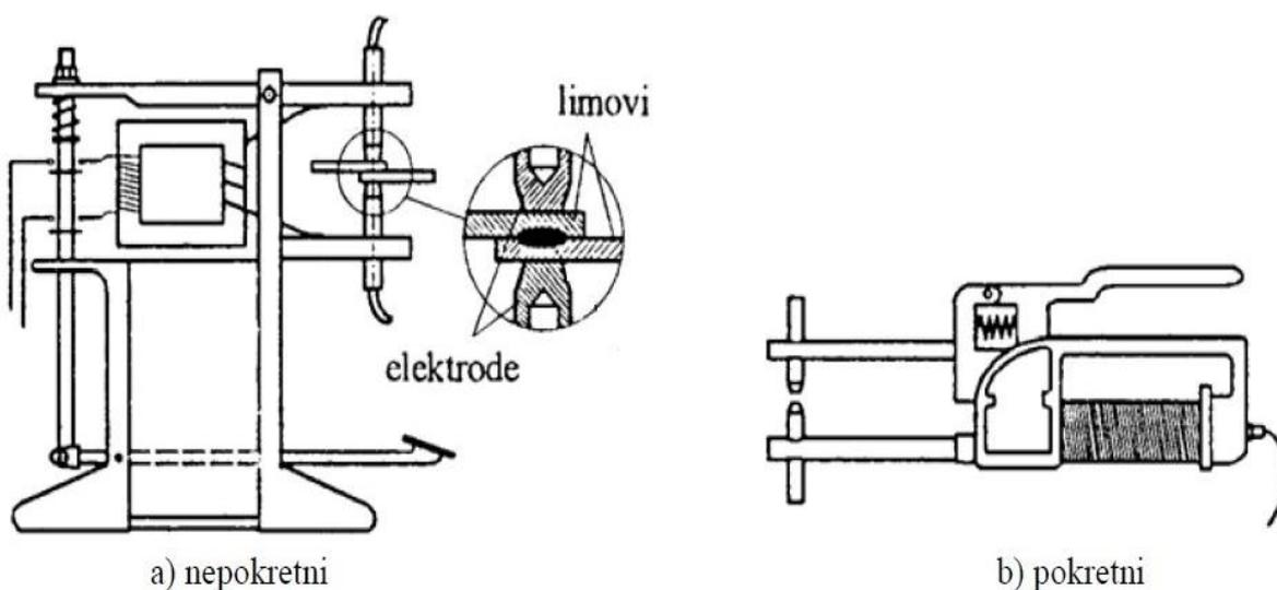
**Slika 12.** Shema uređaja za EO točkasto zavarivanje [15]
