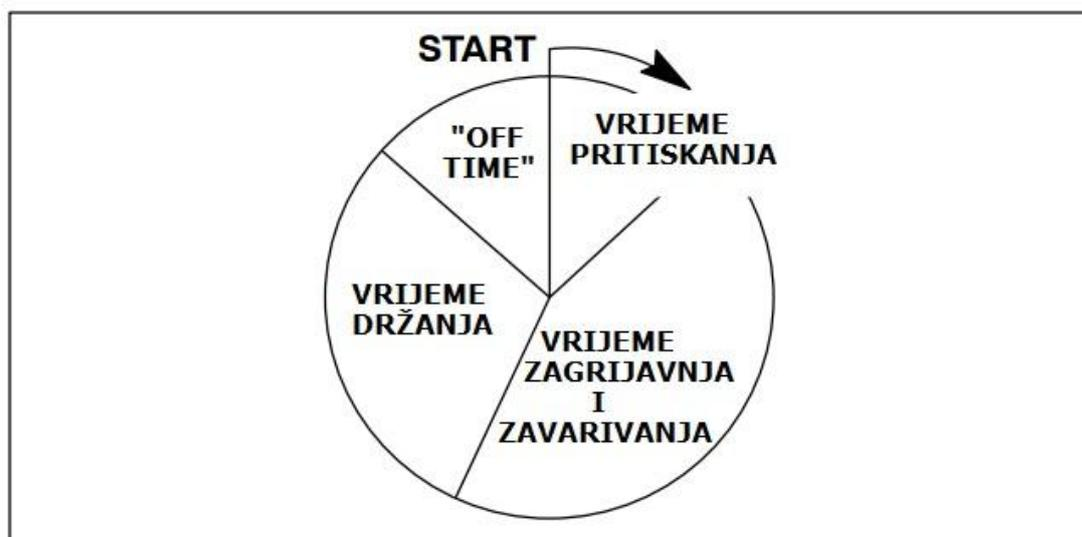
**Slika 8.** Vremenski ciklusi pri elektrootpornom zavarivanju [3]
