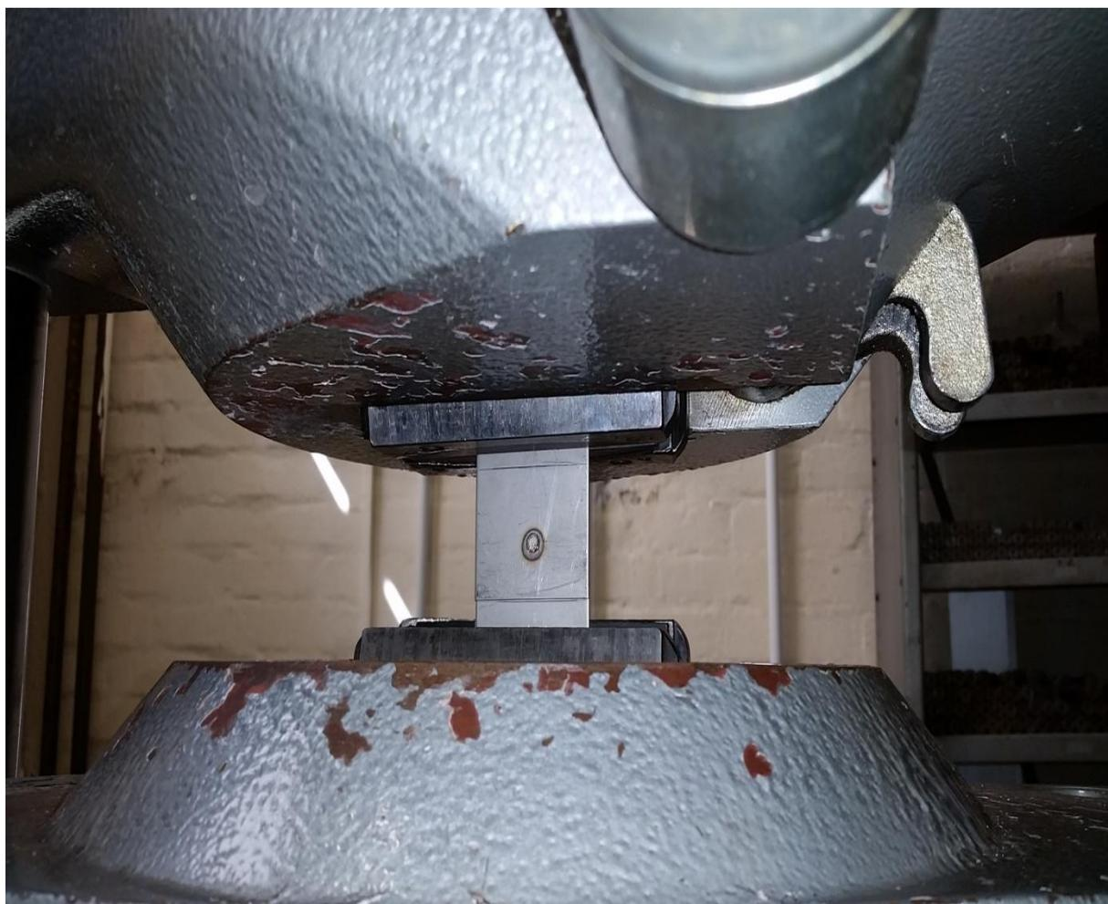
**Slika 37.** Ispitivanje čvrstoće zavara
