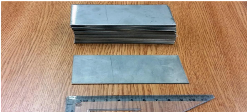
Slika 29. Ispitni uzorci nakon rezanja
