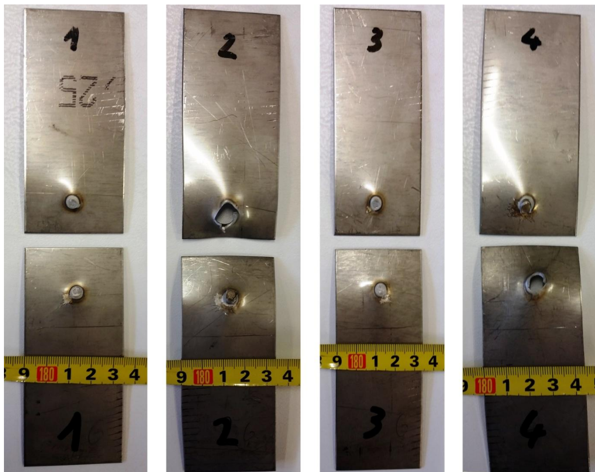
Slika 39. Uzorci 1-4 nakon ispitivanja na kidalici
