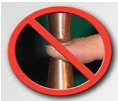
Slika 14. Prikaz ozljeđivanja na mjestu između dvije elektrode [18]
