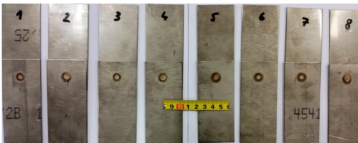
Slika 33.b Naličje zavarene točke (kontakt: radni komad – donja elektroda)
