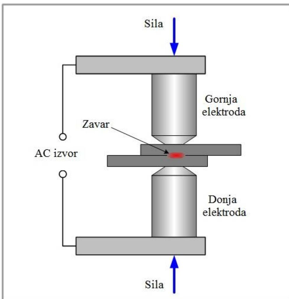
**Slika 2.** Shematski prikaz direktnog točkastog zavarivanja [6]
