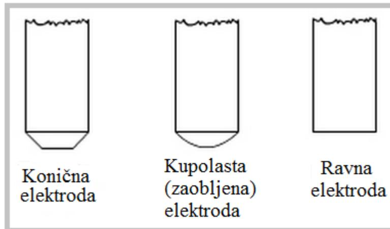
**Slika 17.** Tri najčešća tipa vrha elektrode [23]
