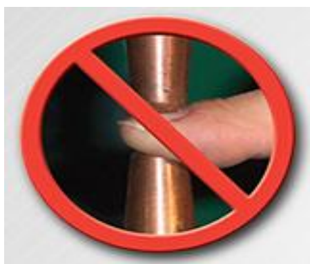
Slika 14. Prikaz ozljeđivanja na mjestu između dvije elektrode [18]
