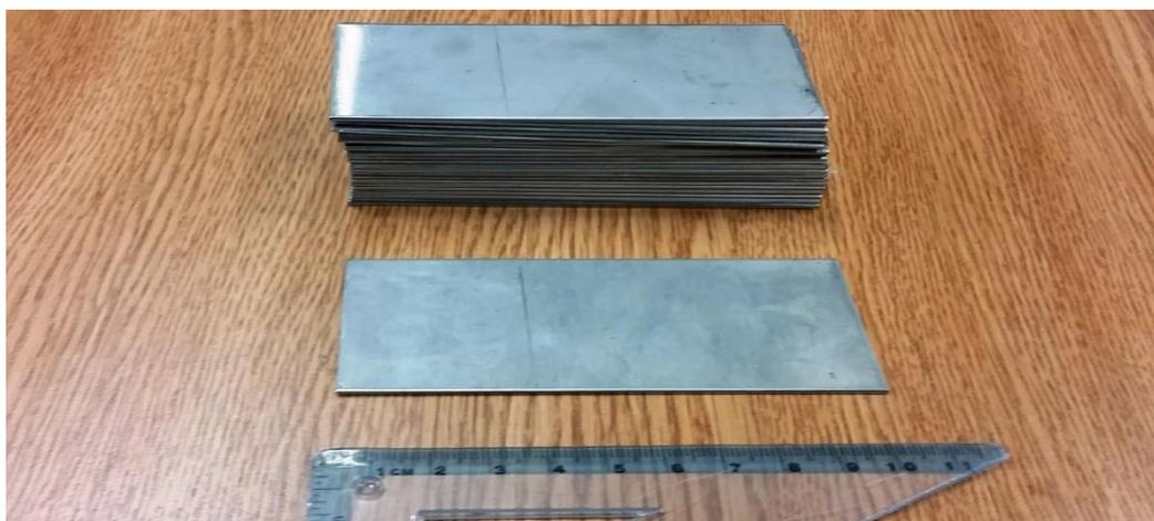
**Slika 29.** Ispitni uzorci nakon rezanja
