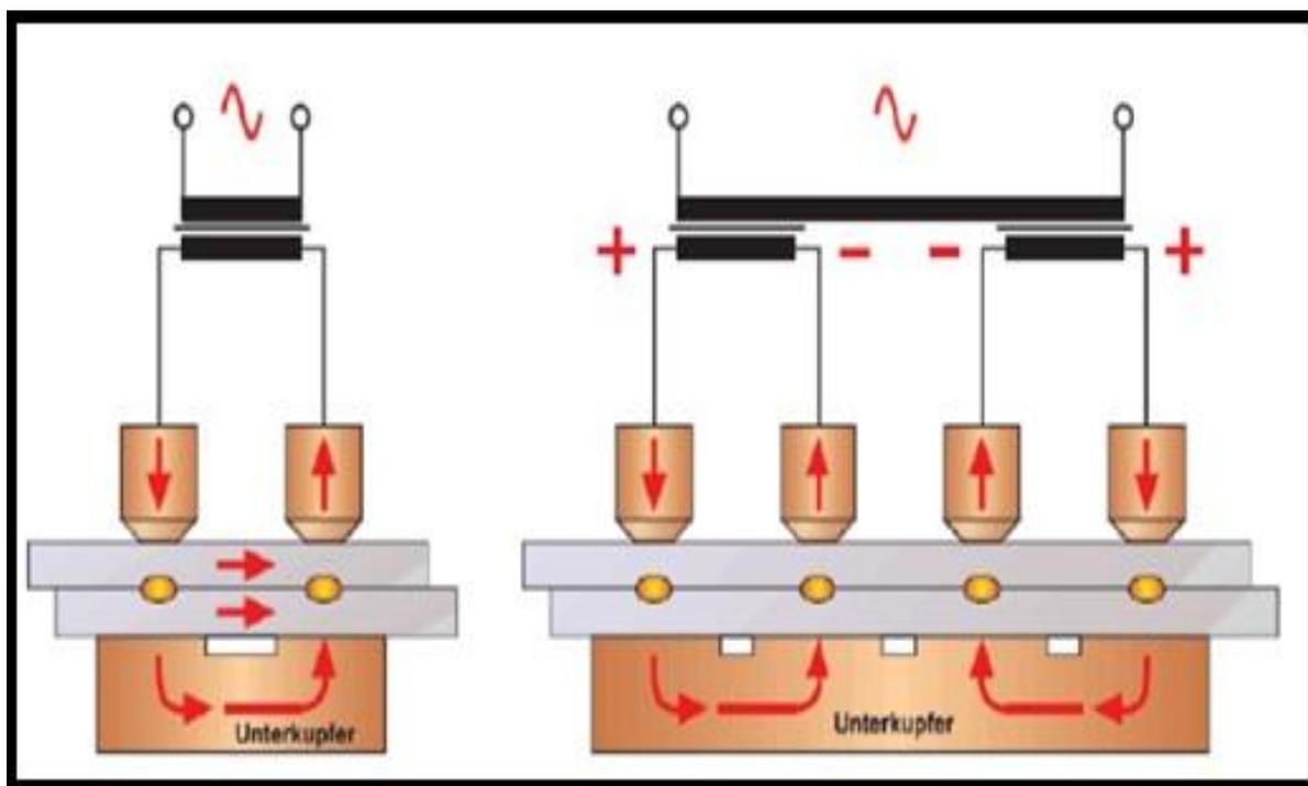
Slika 3. Ilustracija indirektnog točkastog zavarivanja [7]
