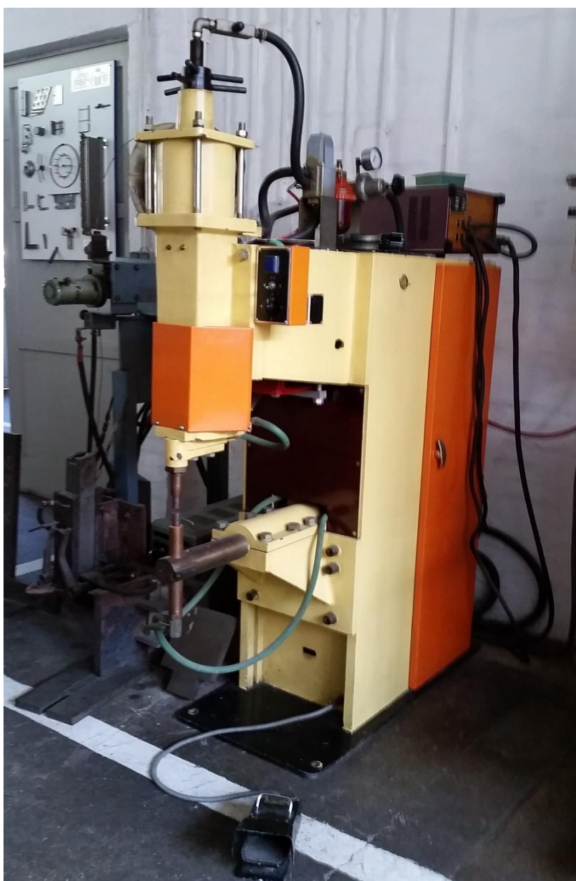
Slika 21. Stroj za EO točkasto zavarivanje na kojem je izveden eksperiment
