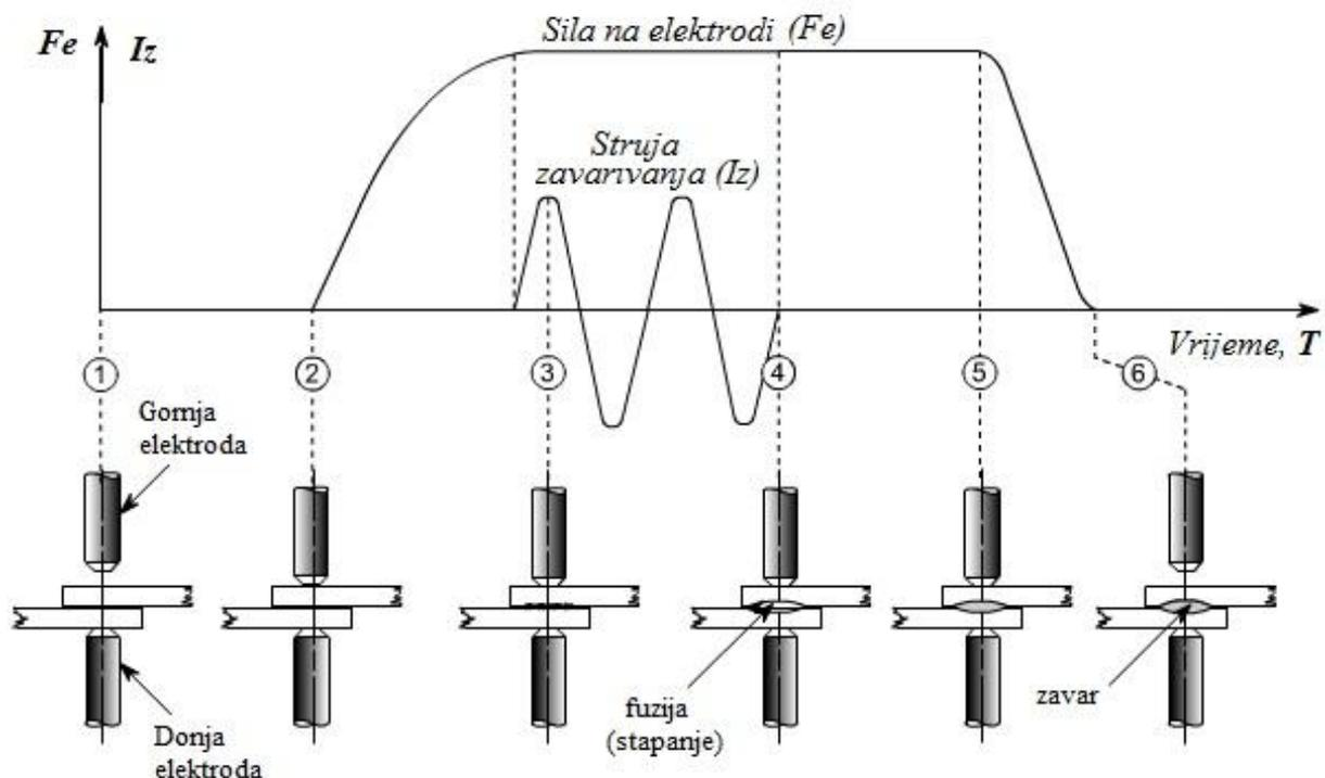
**Slika 6.** Dijagram ovisnosti sile zavarivanja i jačine struje o vremenu [10]
