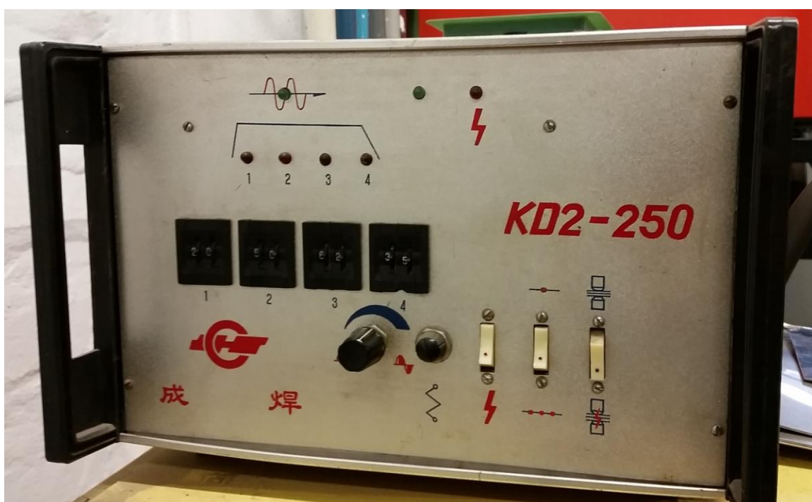
Slika 25. Kontrolni ormarić tipa KD2-250
