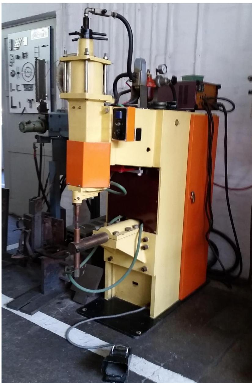
**Slika 21.** Stroj za EO točkasto zavarivanje na kojem je izveden eksperiment
