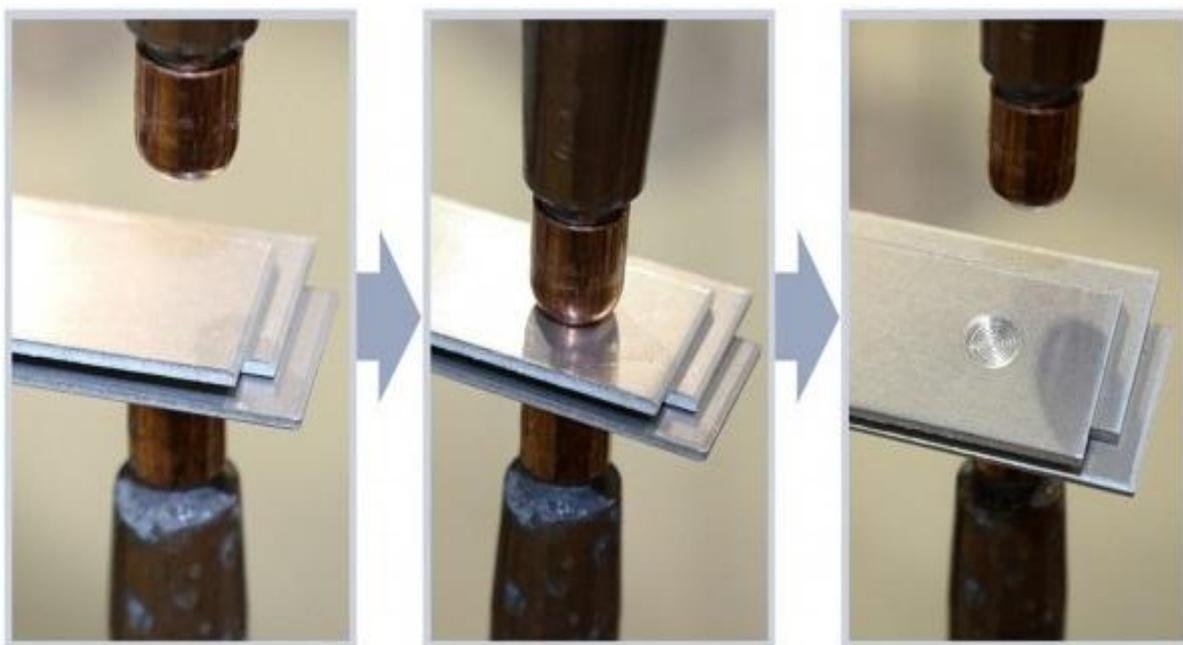
**Slika 11.** EO točkasto zavareni spoja triju aluminijskih limova [14]
