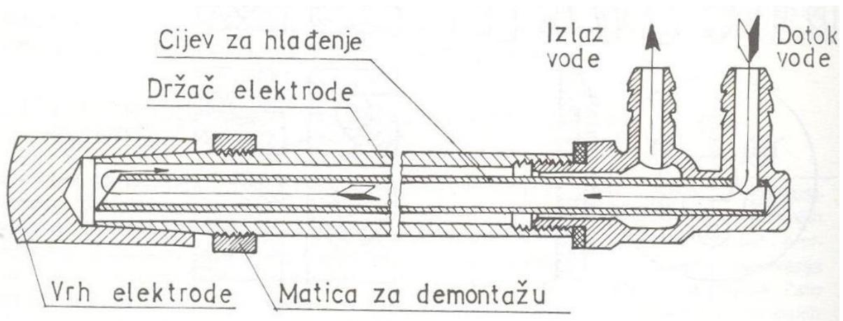
**Slika 18.** Cilindrična ravna elektroda za EO točkasto zavarivanje [7]
