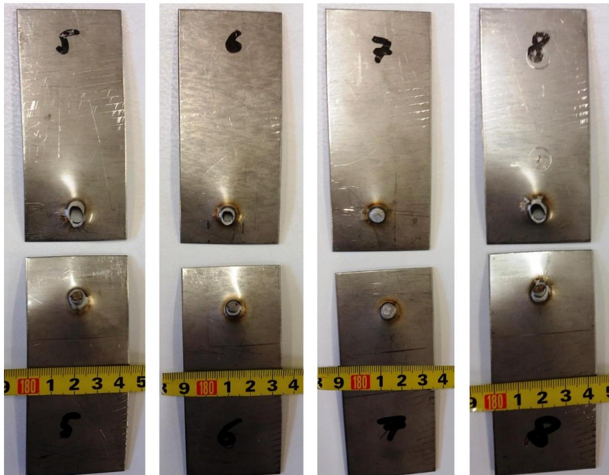
**Slika 40.** Uzorci 5-8 nakon ispitivanja na kidalici
