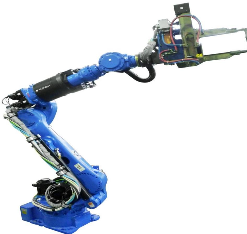
**Slika 19.** Robot za elektrootporno točkasto zavarivanje [26]
