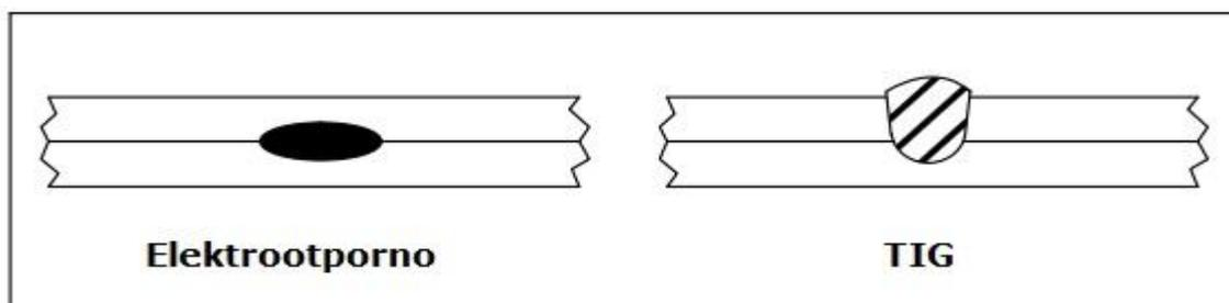
**Slika 10.** Usporedba elektrootpornog i TIG zavarenog spoja [3]
