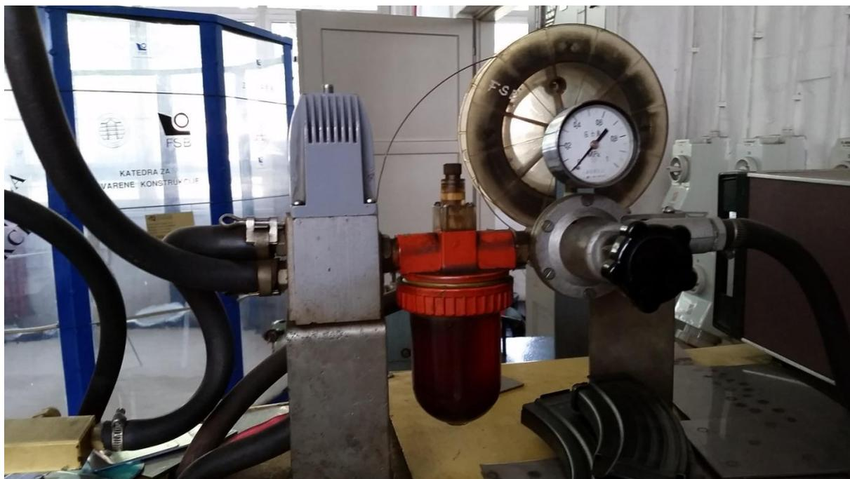
**Slika 24.** Manometar, nauljivač i elektromagnetski razvodnik
