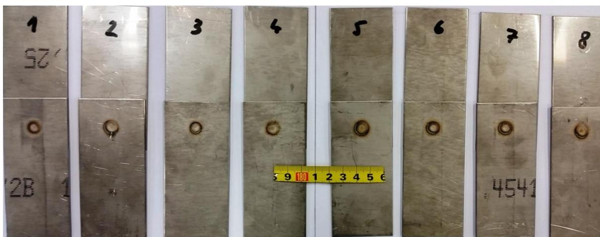
Slika 33.b Naličje zavarene točke (kontakt: radni komad – donja elektroda)
