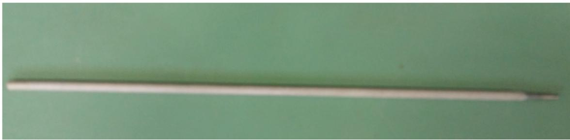
Slika 32. Lastek elektroda za podvodno REL zavarivanje
