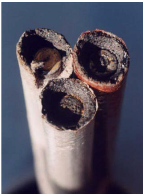
Slika 17. Elektroda Navy 1 i Navy 2 nakon procesa zavarivanja [21]
