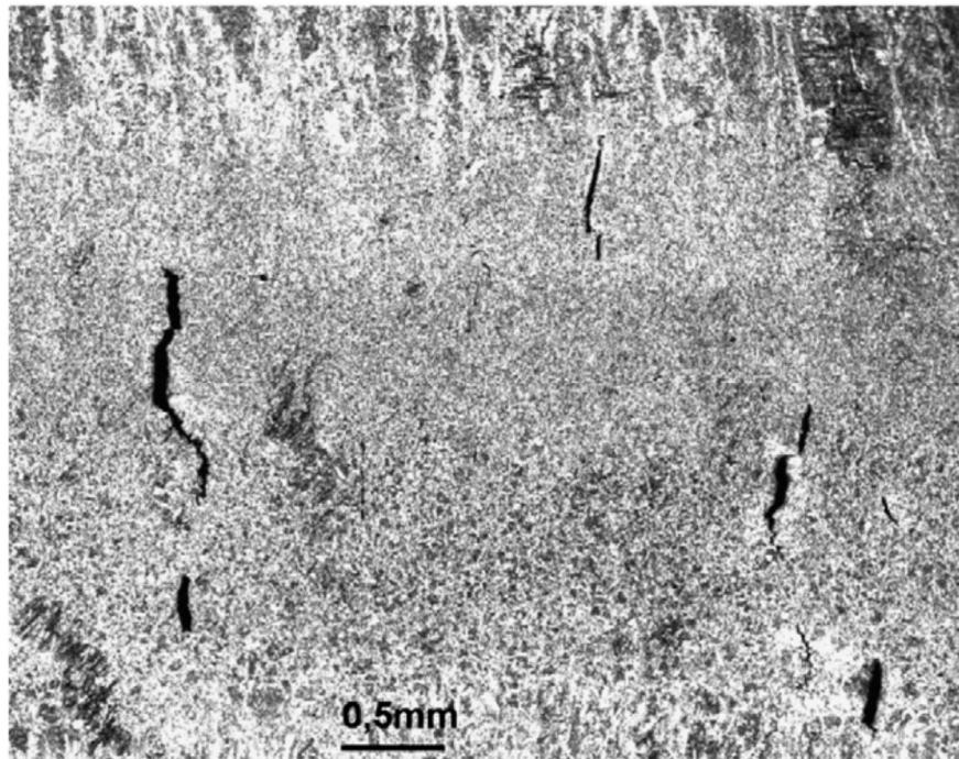
**Slika 7. Hladne pukotine uzrokovane vodikom kod mokrog podvodnog zavarivanja [12]**
