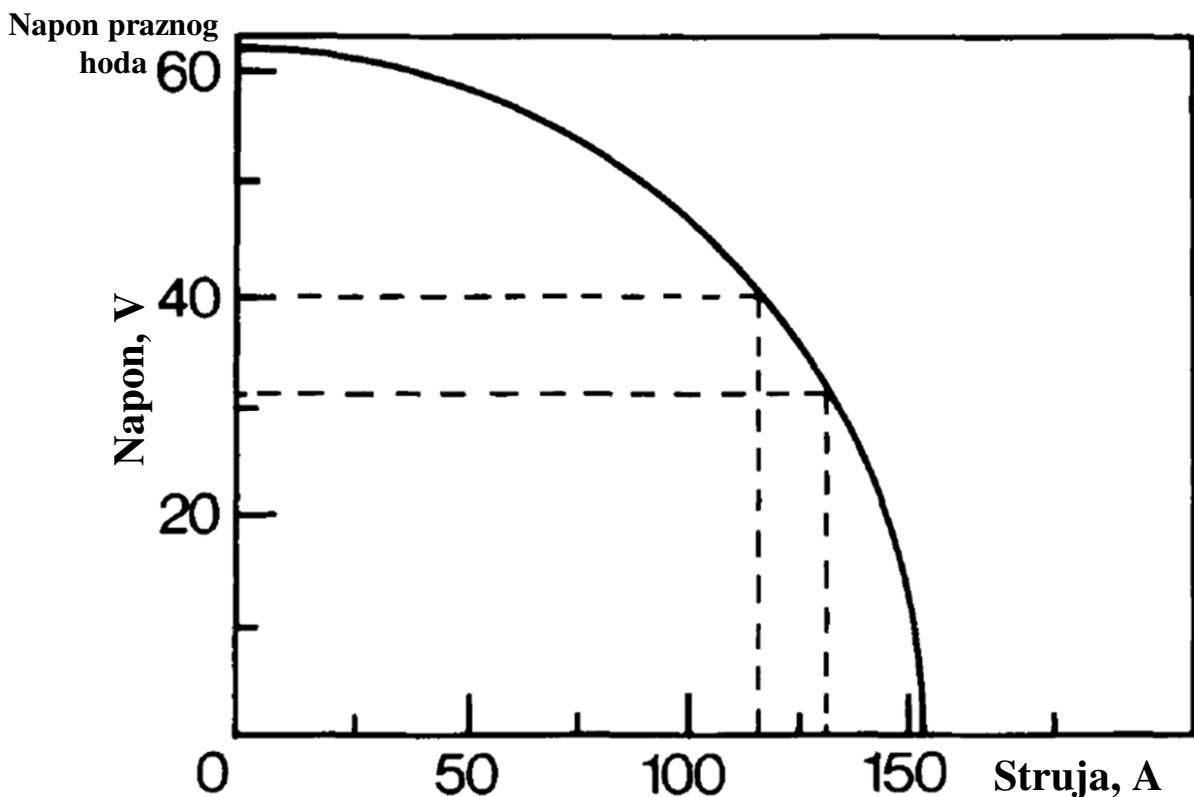
Slika 14. Strmopadajuća karakteristika struje [9]
