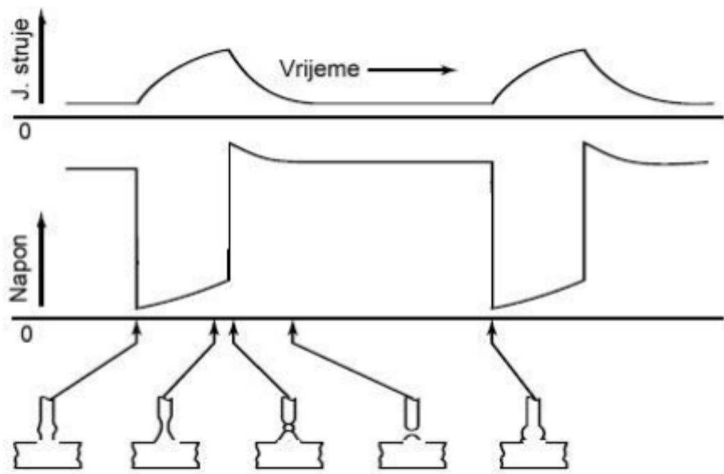
Slika 24. Prikaz dinamičke karakteristike izvora struje zavarivanja [15]
