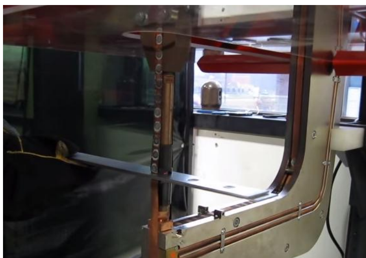
Slika 17. Postupak EO točkastog zavarivanja pocinčanih limova [14]
