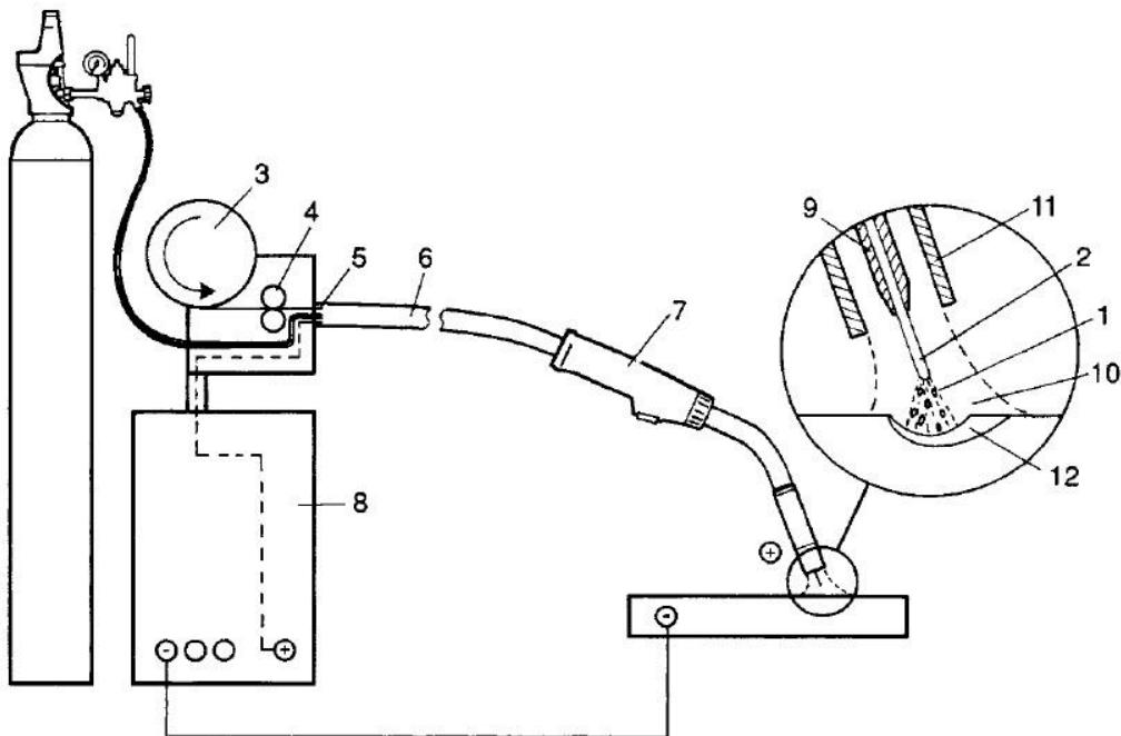
Slika 10. Oprema za zavarivanje s označenim dijelovima [8]
