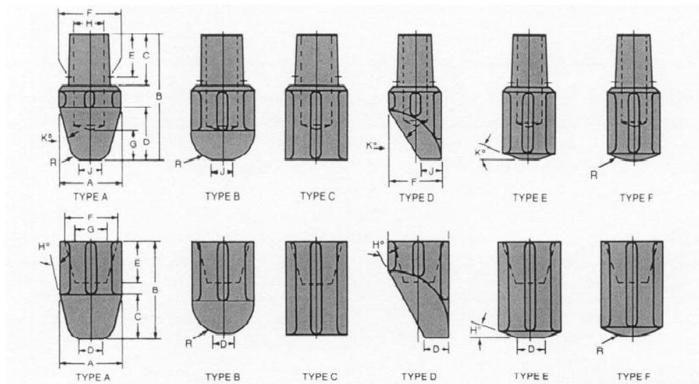
Slika 16. Kapice za elektrode za EO točkasto zavarivanje [13]
