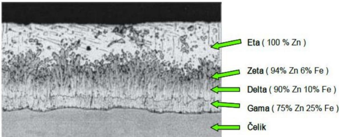
**Slika 1.** Presjek cinkove prevlake izvedene postupkom vrućeg pocinčavanja [2]
