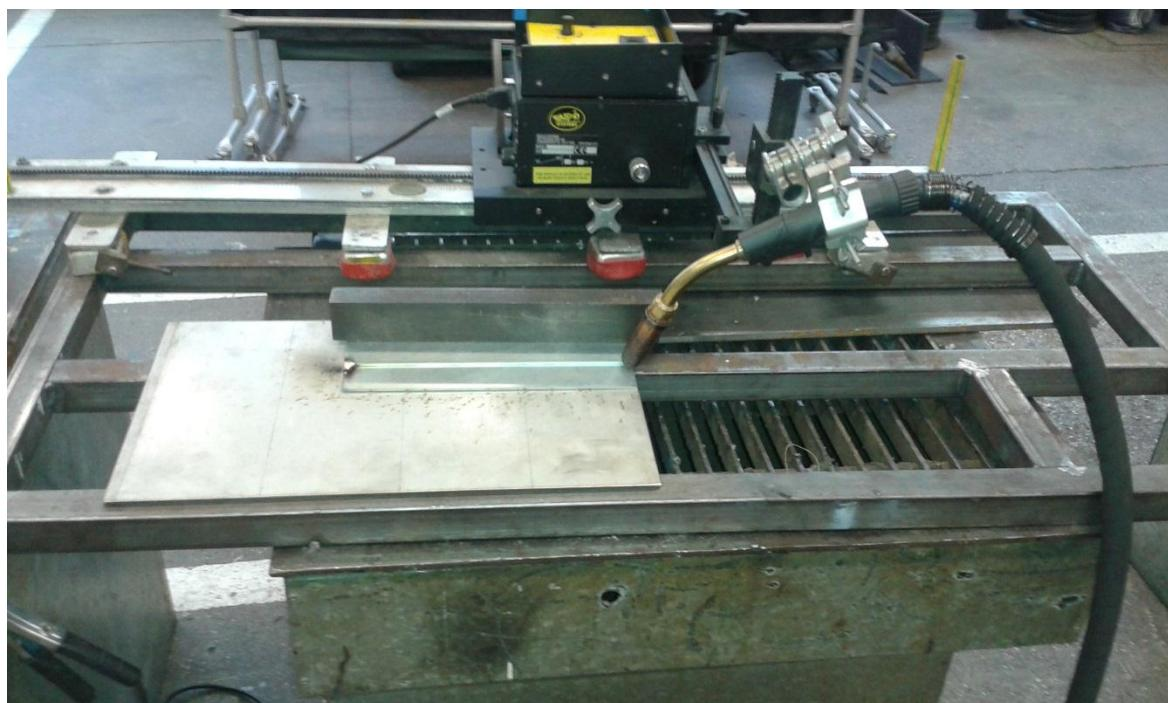
Slika 21. Automat za vođenje pištolja – BUG-O Systems
