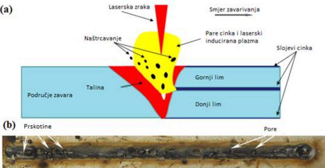
Slika 7. (a) Shematski prikaz laserskog zavarivanja poinčanih limova
