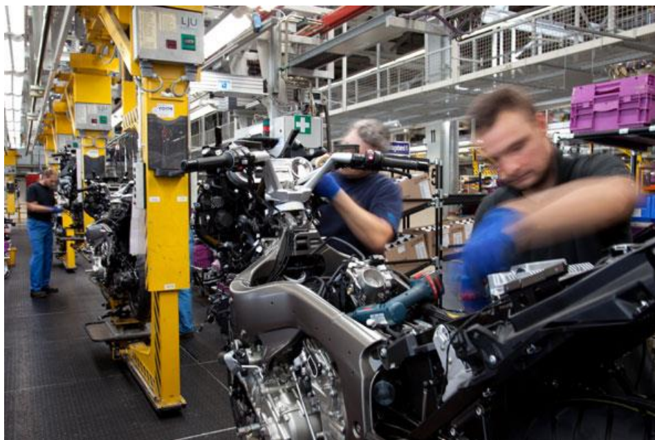
Slika 9. Proizvodnja motocikala na pokretnoj traci [18]
