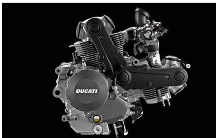
Slika 6. Zrakom hlađeni Ducatijev motor s dva cilindra u obliku slova L [10]
