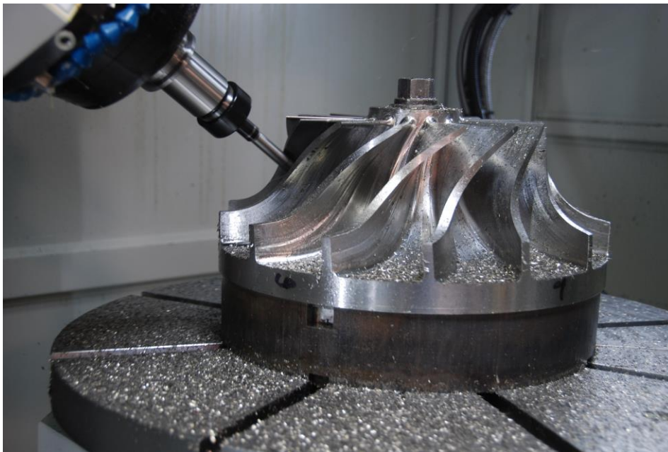
Slika 11 Primjer petoosne obrade lopatice propelera
