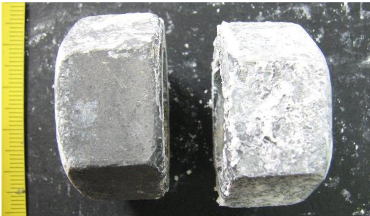
Slika 6.24. Usporedba šerardizirane i vruće cinčane matice [22]
