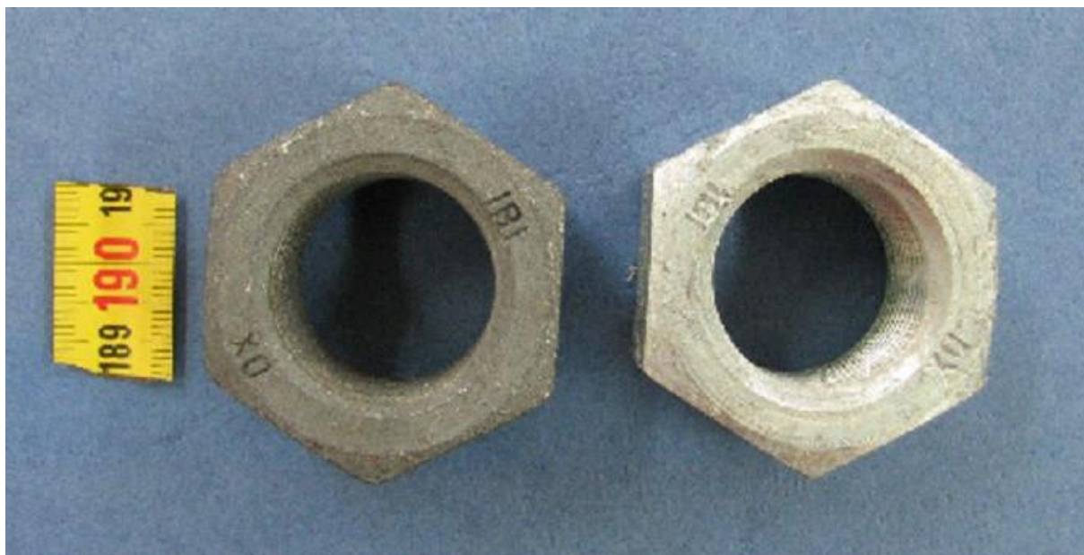
Slika 6.12. Oznake na uzorcima nakon prevlačenja [22]
