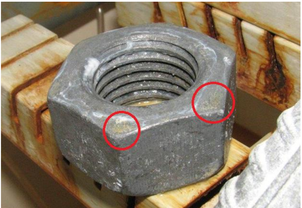
Slika 6.21. Žuti tragovi korozije na šerardiziranoj matici [22]
