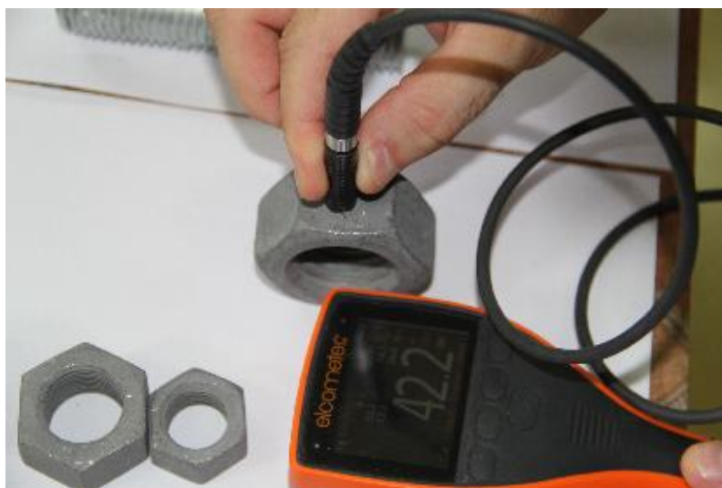
Slika 6.17. Mjerenje debljine prevlake šerardizirane matice [22]
