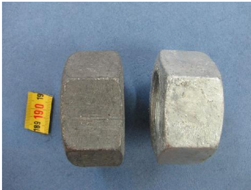
Slika 6.10. Usporedba šerardizirane i vruće cinčane matice [22]
