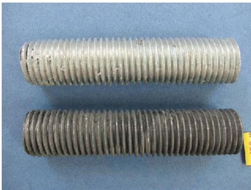
Slika 6.11. Usporedba šerardiziranog i vruće cinčanog vijka [22]
