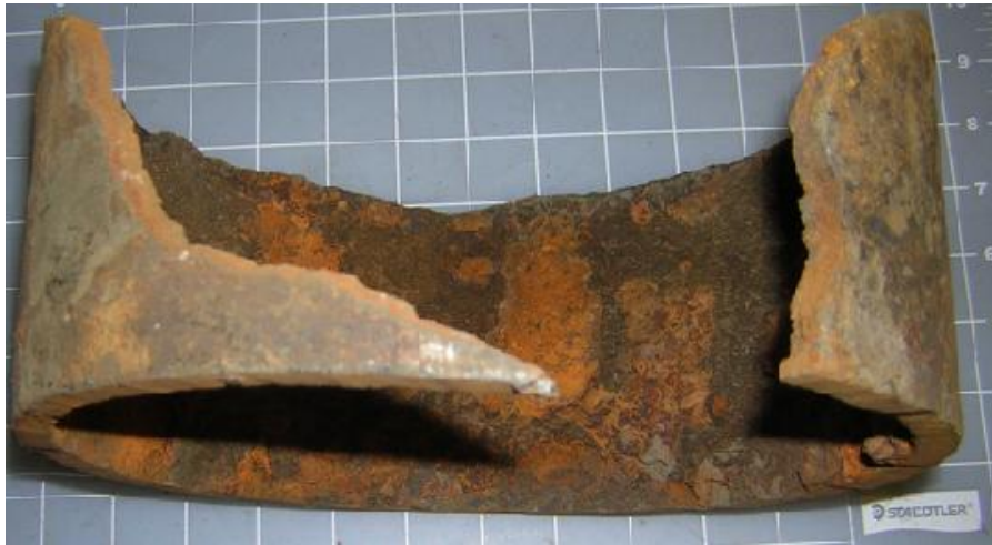
Slika 2.8. Grafitizacija sivog lijeva [16]
