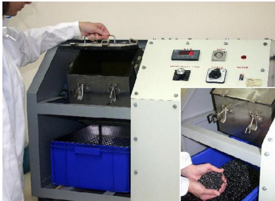
Slika 3.2. Vibracijski uređaj za čišćenje i poliranje [19]
