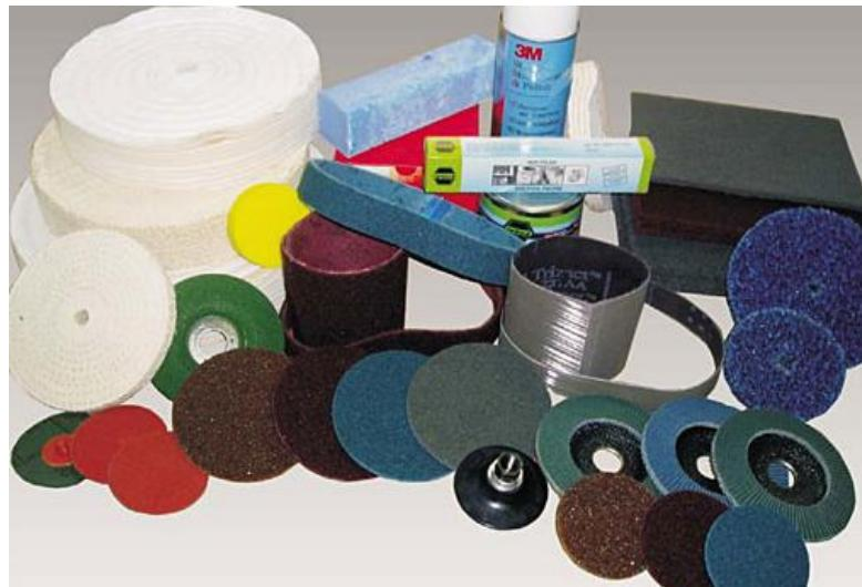
Slika 3.1. Alati i sredstva za brušenje i poliranje [18]
