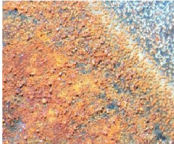
Slika 2.1. Opća korozija [9]
