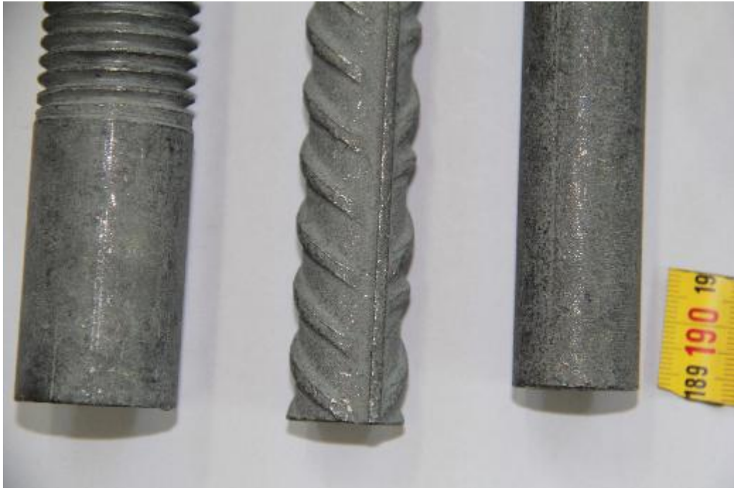
Slika 6.14. Vijci prevučeni postupkom šerardiziranja [22]
