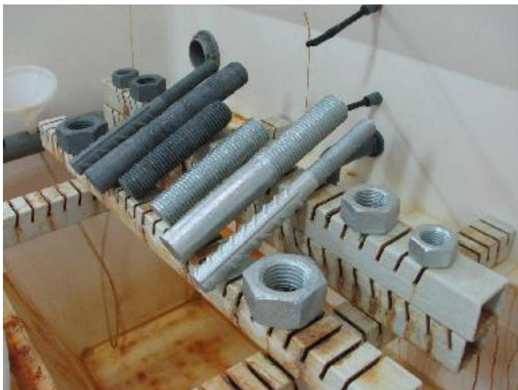
Slika 6.18. Raspored uzoraka u slanoj komori [22]
