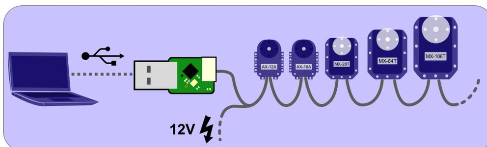
Slika 79: Shematski prikaz spoja USB2AX i servo motora
