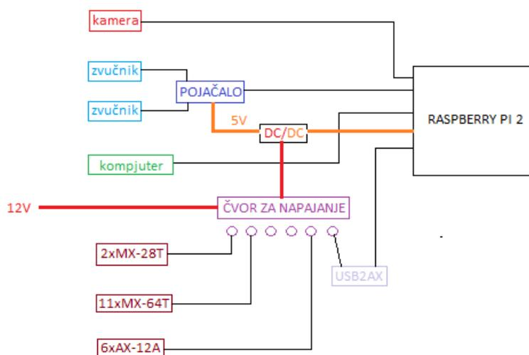
Slika 85: Shema konfiguracije upravljačkog i energetskeg sustava
