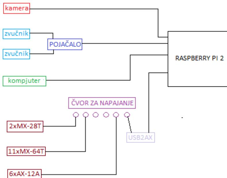
Slika 81: Shema konfiguracije upravljačkog sustava
