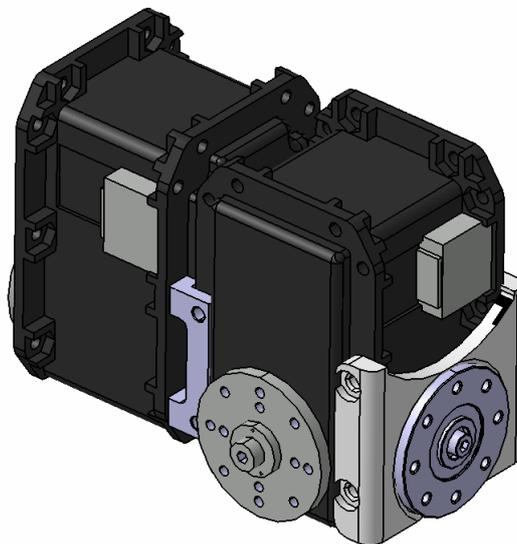
Slika 20: Sklop motora za rotaciju oko dvije osi
