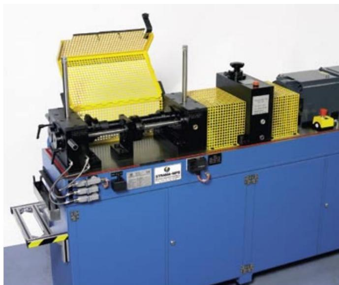
Slika 2.2 Realna izvedba FZG uređaja; [5]
