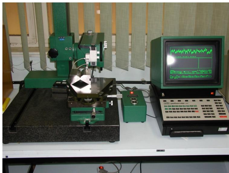
Slika 21. Elektromehanički uređaj za ispitivanje hrapavosti površine MU2-127
