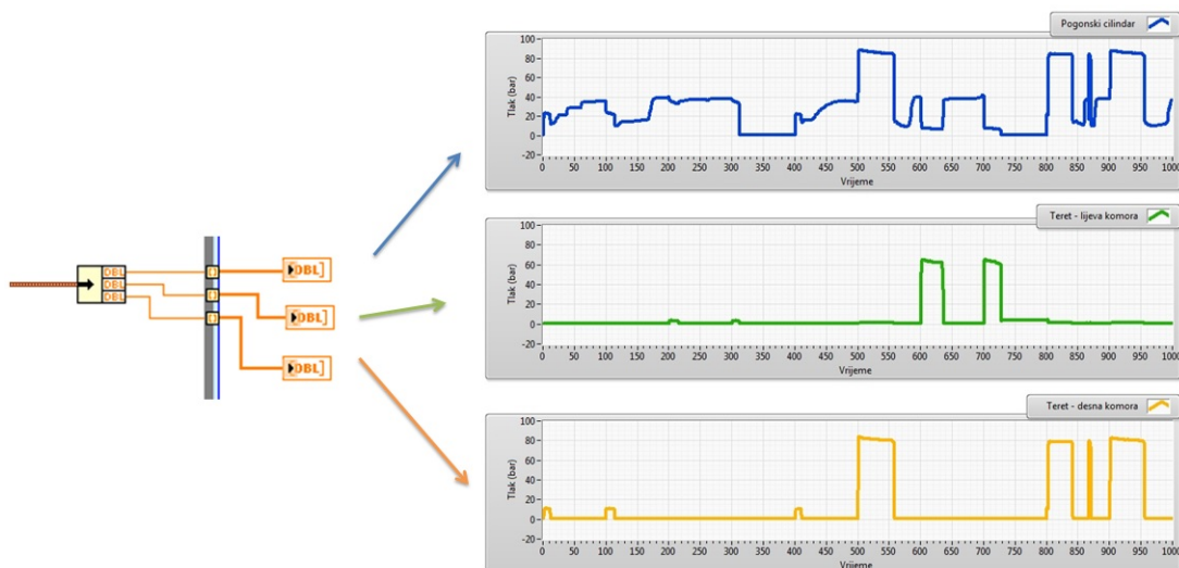
Slika 60: Prikaz tlakova u komorama na kraju procesa
