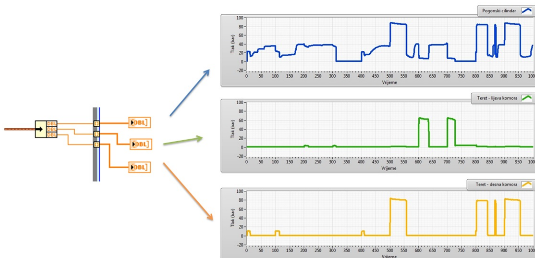
Slika 60: Prikaz tlakova u komorama na kraju procesa
