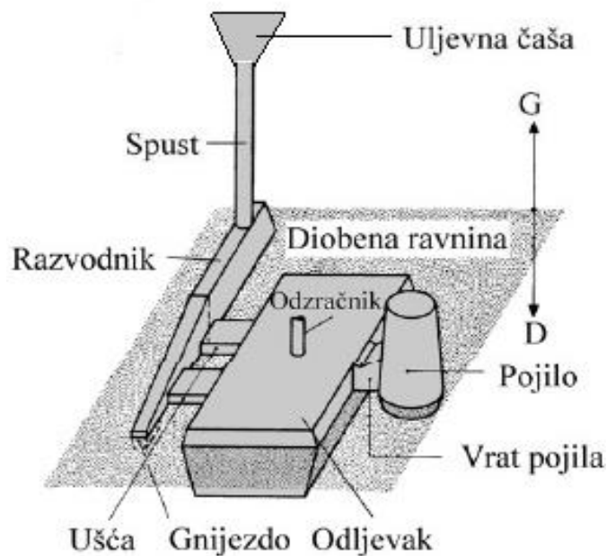
Slika 7. Uljevni sustav
