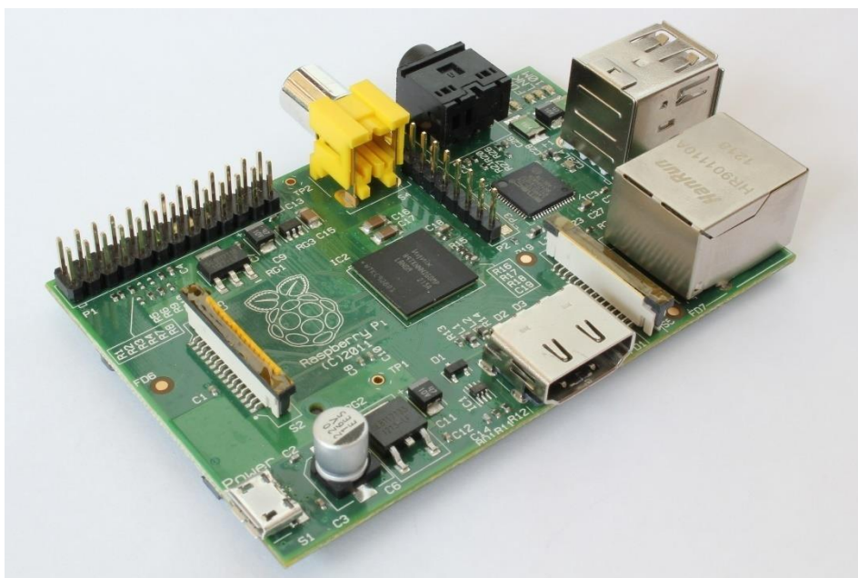
Slika 3 Računalo Raspberry Pi
