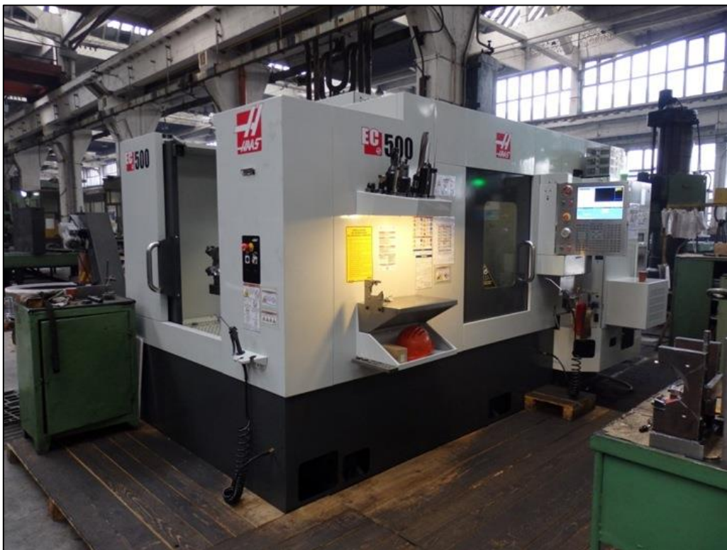
Slika 20. Obradni centar HAAS EC-500 [29]
