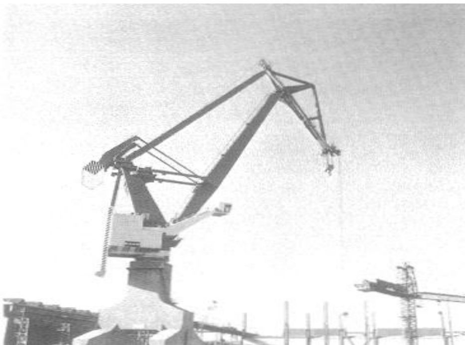
Slika 43. Pokretno-prihvatna dizalica s dvostrukom granom [8]
