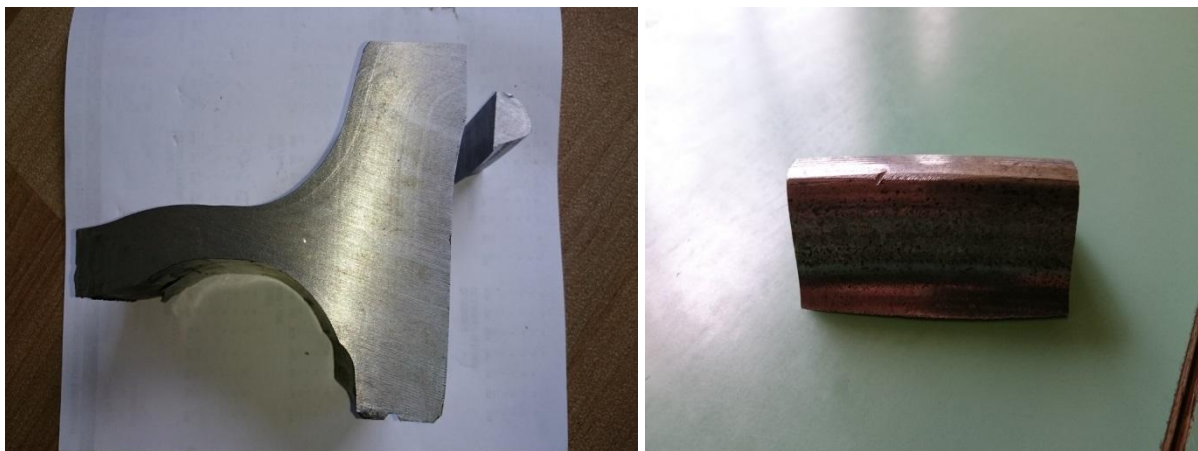
Slika 47. Izrezani vijenac monoblok kotača
