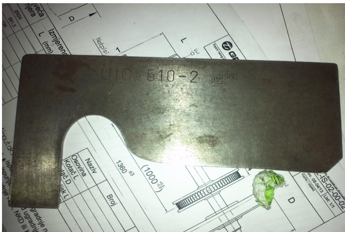
Slika 31. Mjerka za kontrolu vijenca i profil kotača
