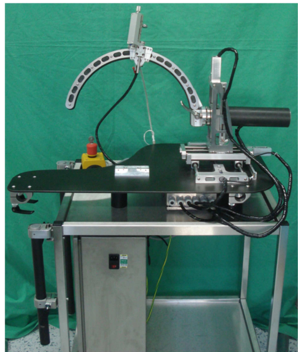
Slika 9: MARS sustav za stereotaktičku navigaciju montiran na postolje u kojoj se nalazi napajanje i upravljačka jedinica robota [19]
