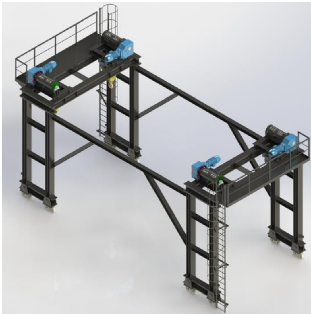
Slika 7.20. Sklop portalne dizalice
