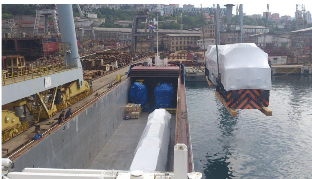
Slika 2.5. Pretovar lokomotiva portalnim granikom
