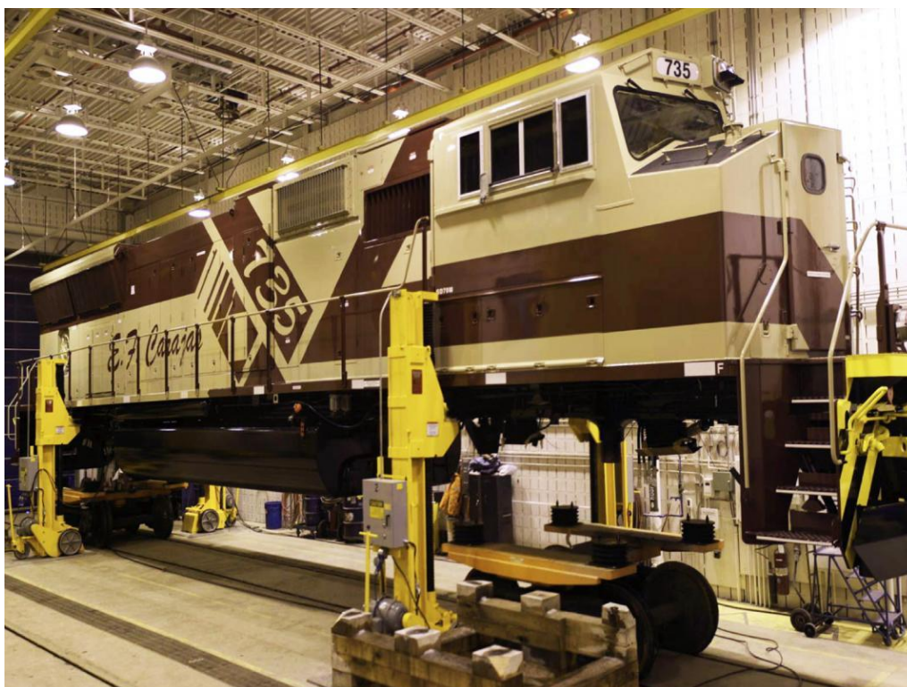
Slika 2.1. Podizanje lokomotive sa 4 mobilne električne dizalice [9]
