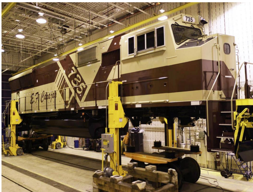
Slika 2.1. Podizanje lokomotive sa 4 mobilne električne dizalice [9]
