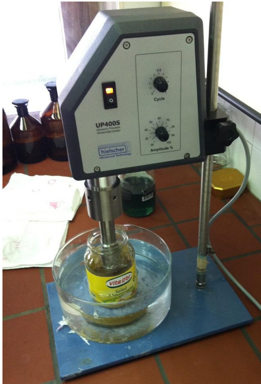
Slika 16. Uredaj s ultrazvučnom sondom sa disperziju čestica jarosita u poliesterskoj smoli
