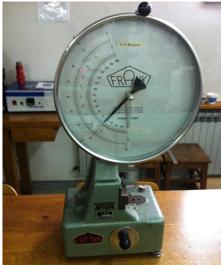
Slika 14. Ispitivanje udarne žilavosti pomoću Charpyevog bata
