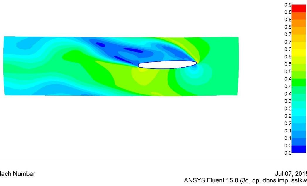
**Slika 34.** Vrijednosti Machova broja po uzdužnom presjeku domene, na sredini visine rebra pri vanprojektном opterećenju
