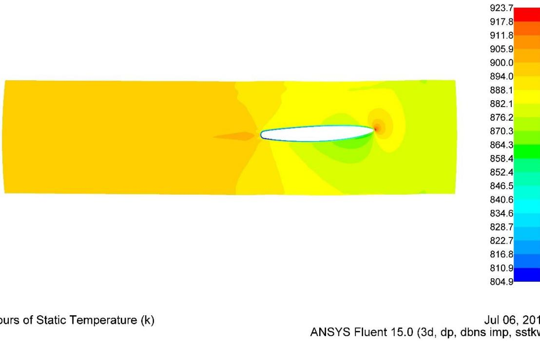
**Slika 24. Detalj presjeka po uzdužnom presjeku domene, na sredini visine rebra pri projektnom opterećenju s pripadajućim temperaturnim poljem**
