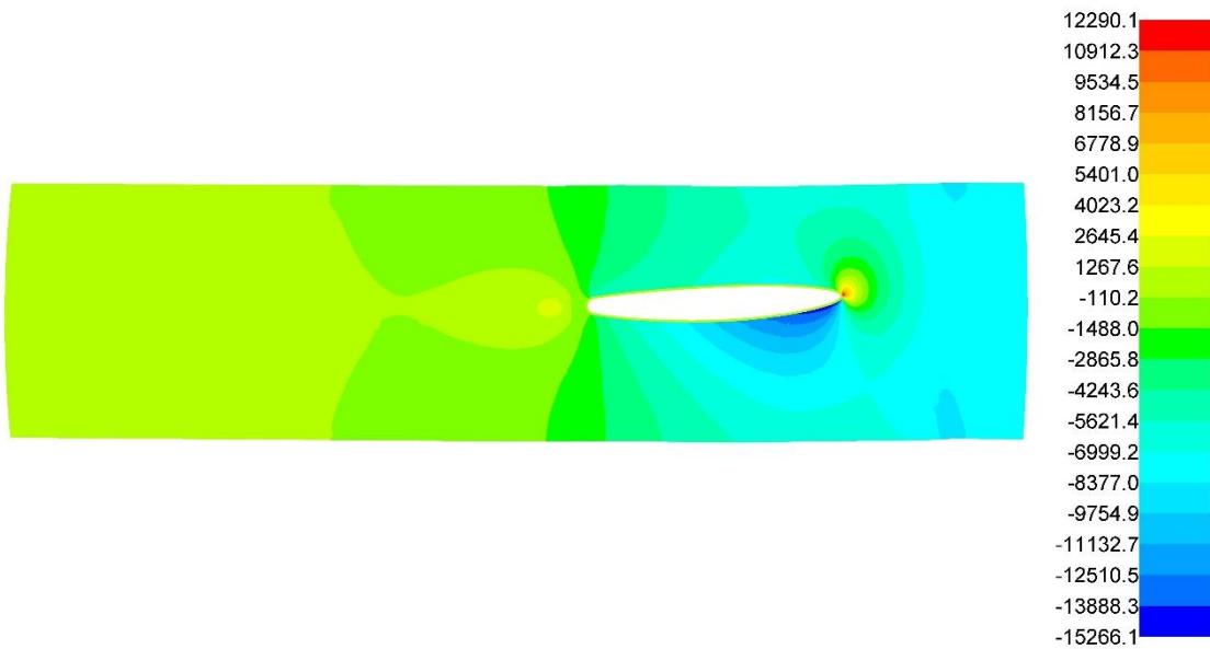
**Slika 19. Polje tlaka u uzdužnom presjeku domene, na sredini visine rebra pri projektnom opterećenju**
