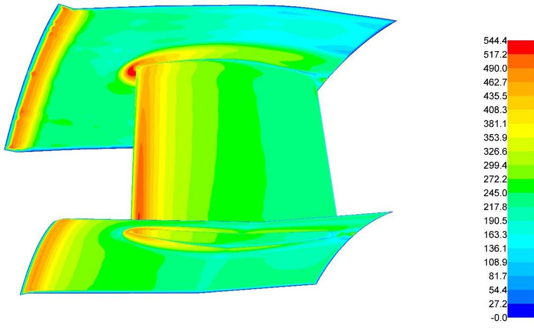
**Slika 30. Koeficijent prijelaza topline s dimnih plinova na stijenke linera pri projektnom opterećenju - pogled s desna**
