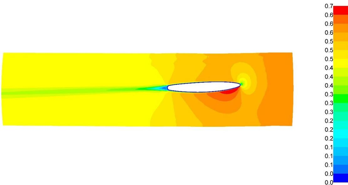
**Slika 20. Vrijednosti Machova broja po uzdužnom presjeku domene, na sredini visine rebra pri projektnom opterećenju**
