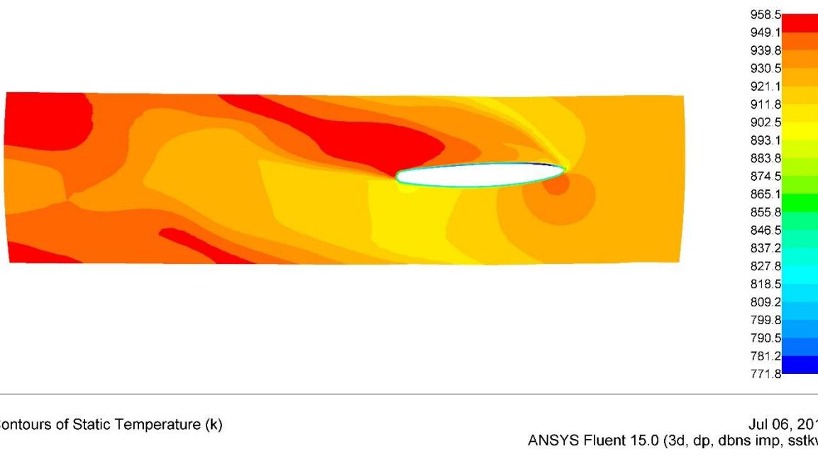
**Slika 38. Detalj presjeka po uzdužnom presjeku domene, na sredini visine rebra pri vanprojektnom opterećenju s pripadajućim temperaturama**
