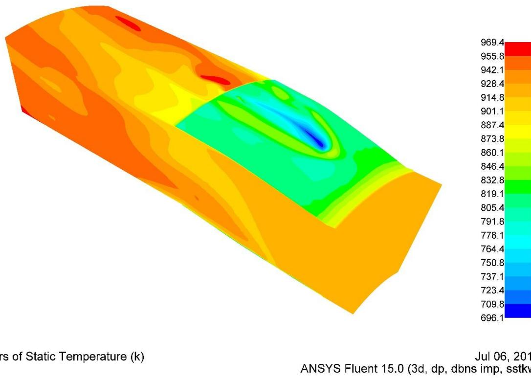
**Slika 37. Temperaturna distribucija po površinama domene linera i domene fluida pri vanprojektnom opterećenju**
