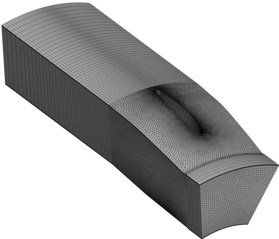
**Slika 11. Vidljiva – površinska discretizacija domene fluida**
