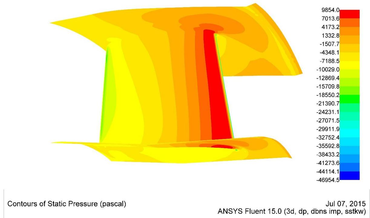
Slika 35. Raspodjela tlaka po stijenkama linera pri vanprojektnom opterećenju – pogled s lijeva
