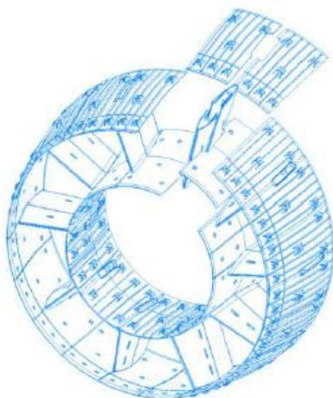
Slika 1. Liner ispušnog kućišta plinske turbine
