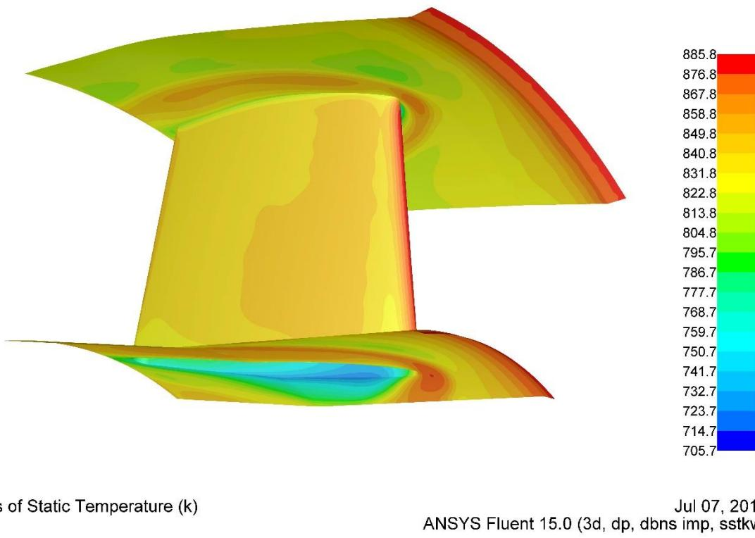
**Slika 39.** Temperaturno polje po stijenkama linera pri vanprojektnom opterećenju – pogled s lijeva
