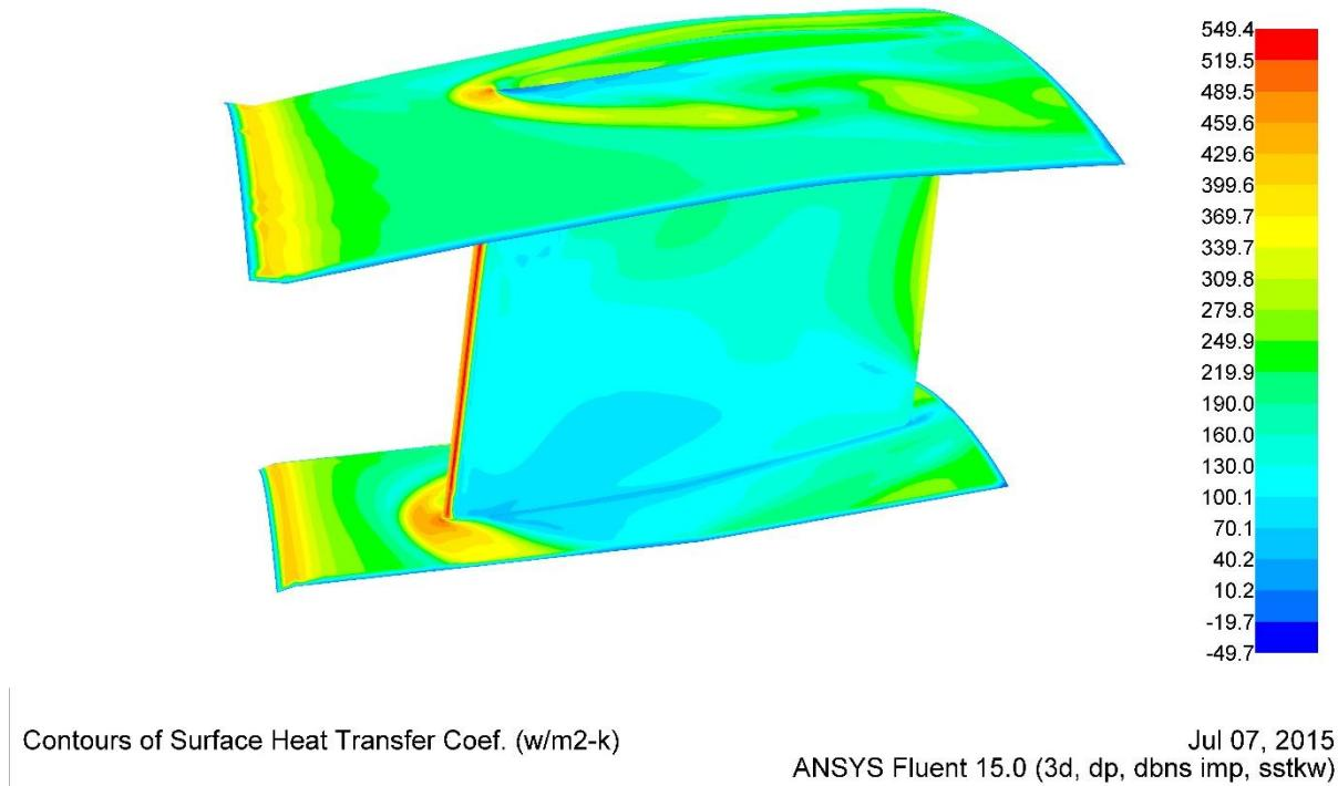
**Slika 44.** Koeficijent prijelaza topline sa dimnih plinova na stijenke linera pri projektnom opterećenju - pogled s desna
