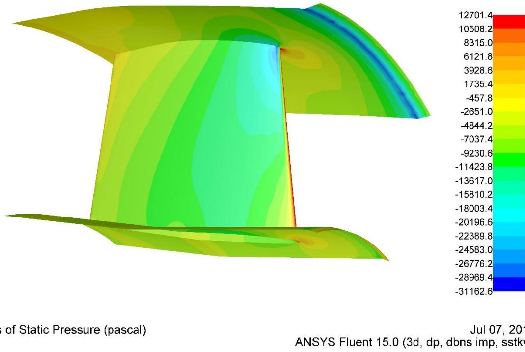
Slika 21. Raspodjela tlaka po stjenkama linera pri projektnom opterećenju – pogled s lijeva
