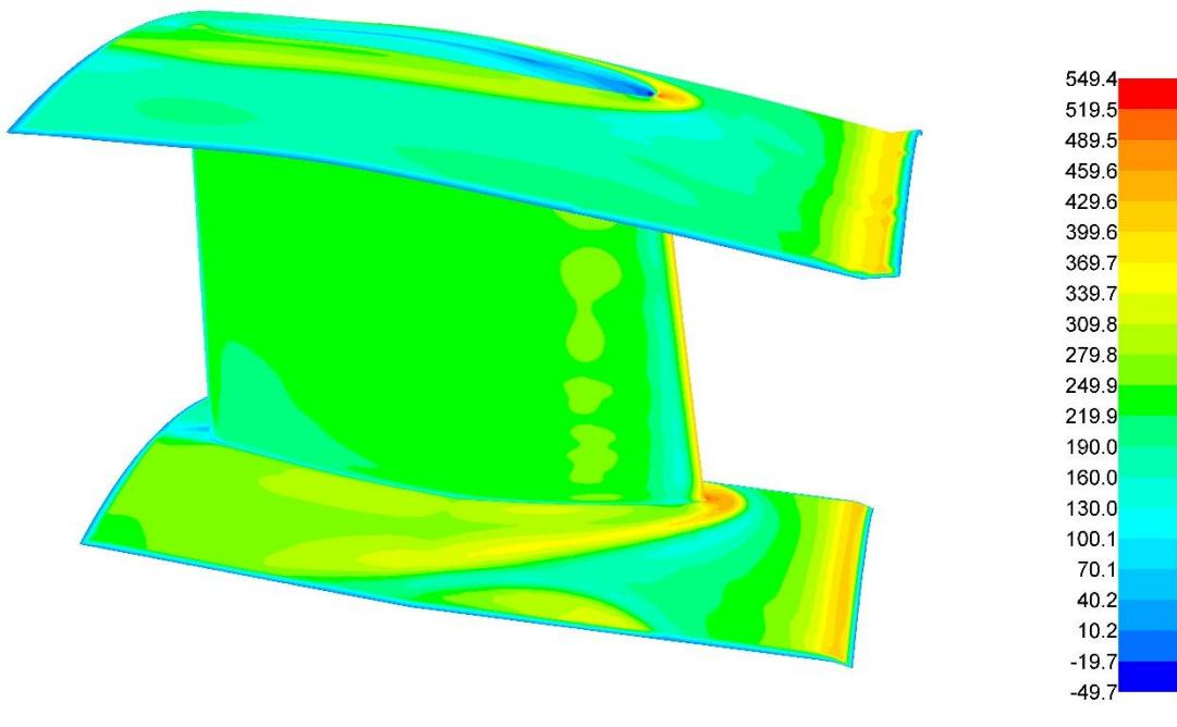
**Slika 43. Koeficijent prijelaza topline sa dimnih plinova na stijenke linera pri vanprojektnom opterećenju - pogled s lijeva**
