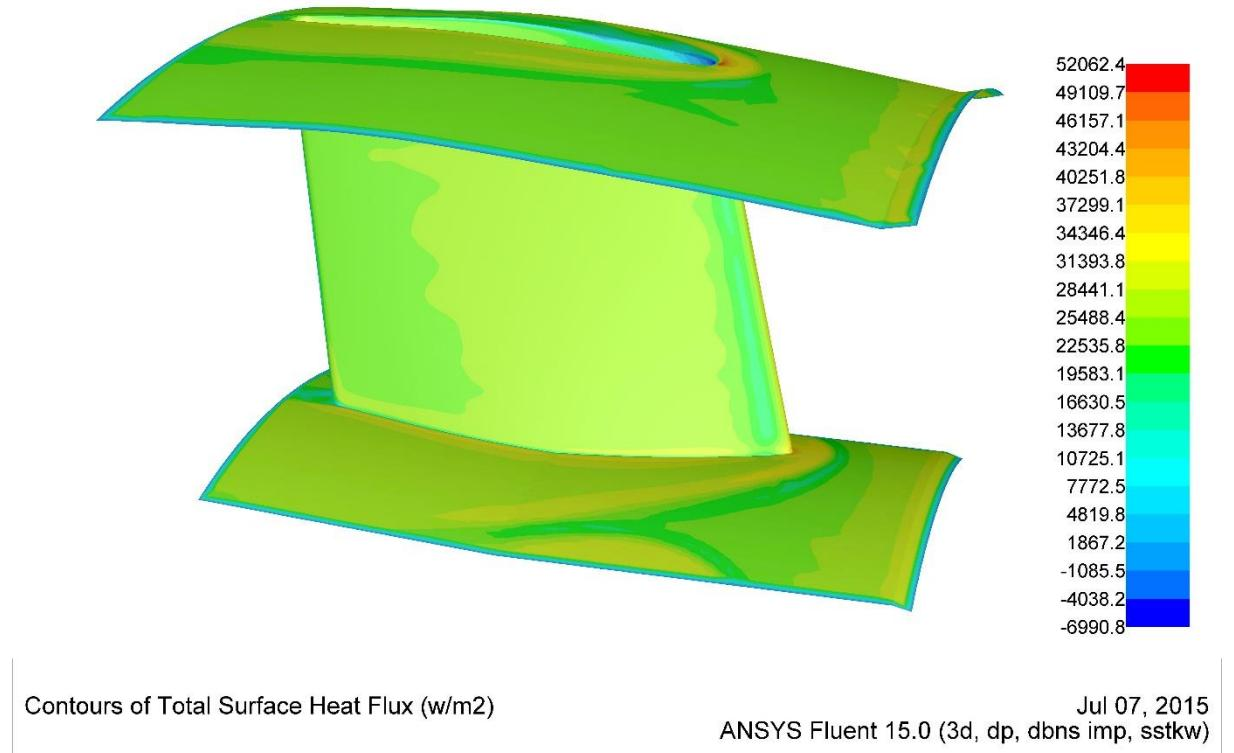
Slika 41. Gustoća toplinskog toka na stijenkama linera pri vanprojektnom opterećenju – pogled s lijeva
