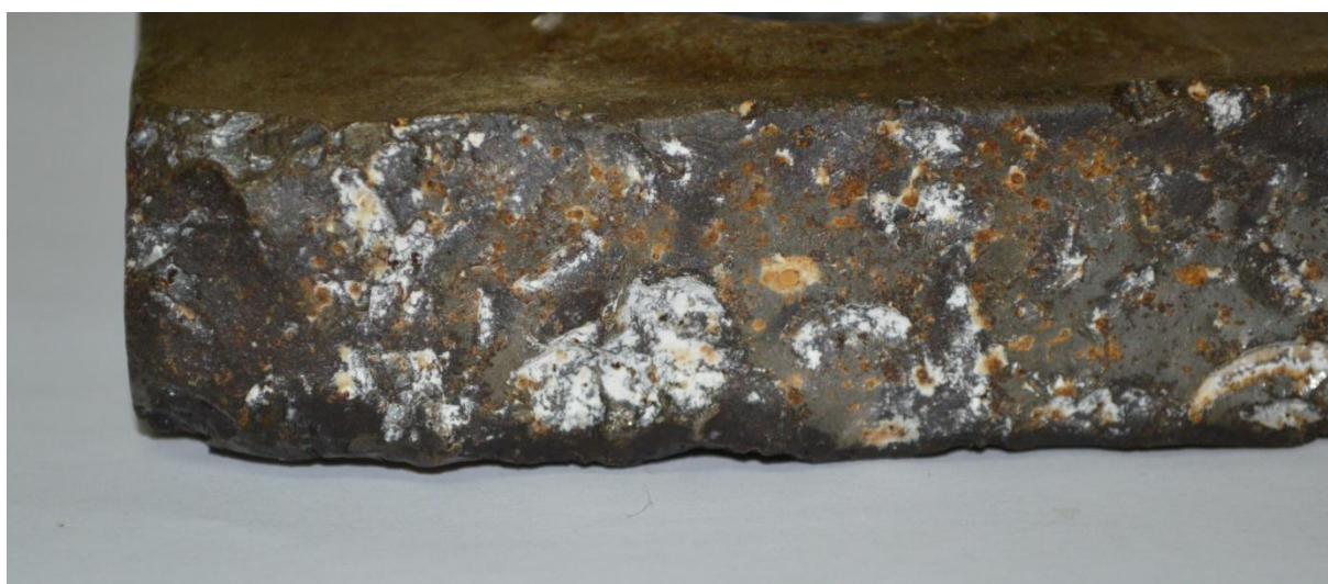
Slika 45. Tragovi trošenja kidanjem materijala
