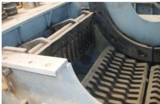
Slika 22. Udarne obloge drobilice izložene trošenju [17]
