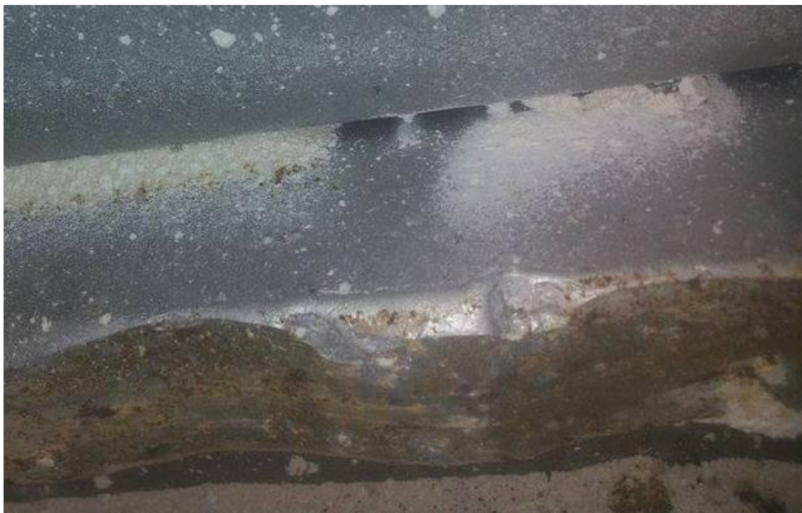
Slika 48. Tragovi trošenja na udarnim oblogama, detalj
