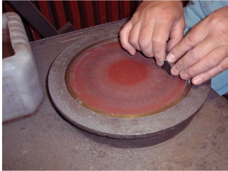
Slika 5.14. Brušenje makroizbrusaka brusnim papirom
