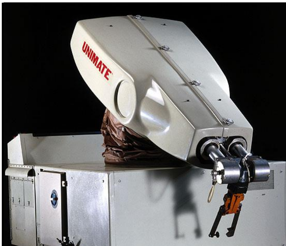
Slika 1. UNIMATE – prvi industrijski robot
