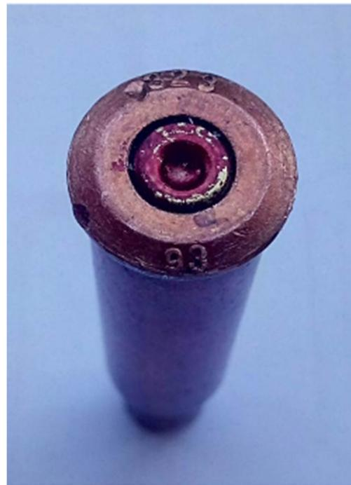
**Slika 34. Čahura iskorištenog standardnog metka 7,62x51 s bakrenom košuljicom**
