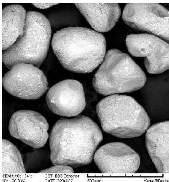
Slika 38. čestice erodenta SiO 2 snimljene pretražnim elektronskim mikroskopom [45].
