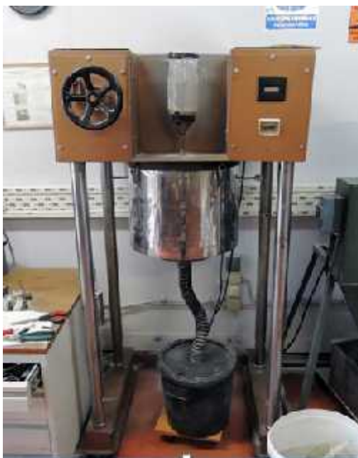
Slika 35. Uređaj za ispitivanje otpornosti na erozijsko trošenje [45].
