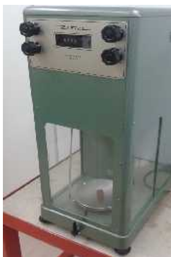
Slika 36. Mjerenje uzoraka na analitičkoj vagi Mettlers [37].
