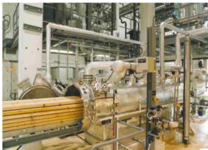
Slika 9. Komora za kemijsku modifikaciju drva [27].
