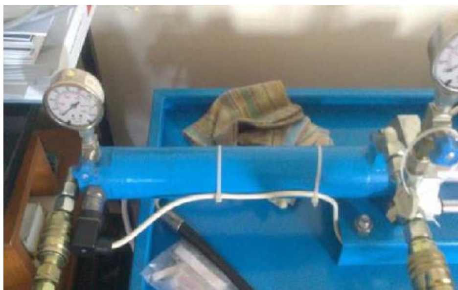
Slika 2.7 Pogonski dvoradni cilindar na laboratoriskom postavu
