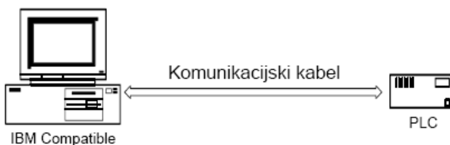
Slika 3.2 Komunikacija računala i PLC-a
