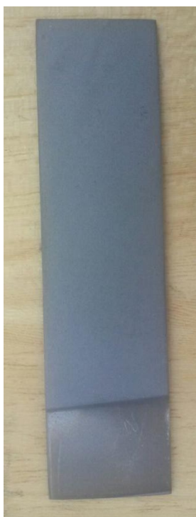
Slika 23. Dobiveni uzorak \text{Cr}_3\text{C}_2 prevlake HVOF postupkom naštrcavanja
