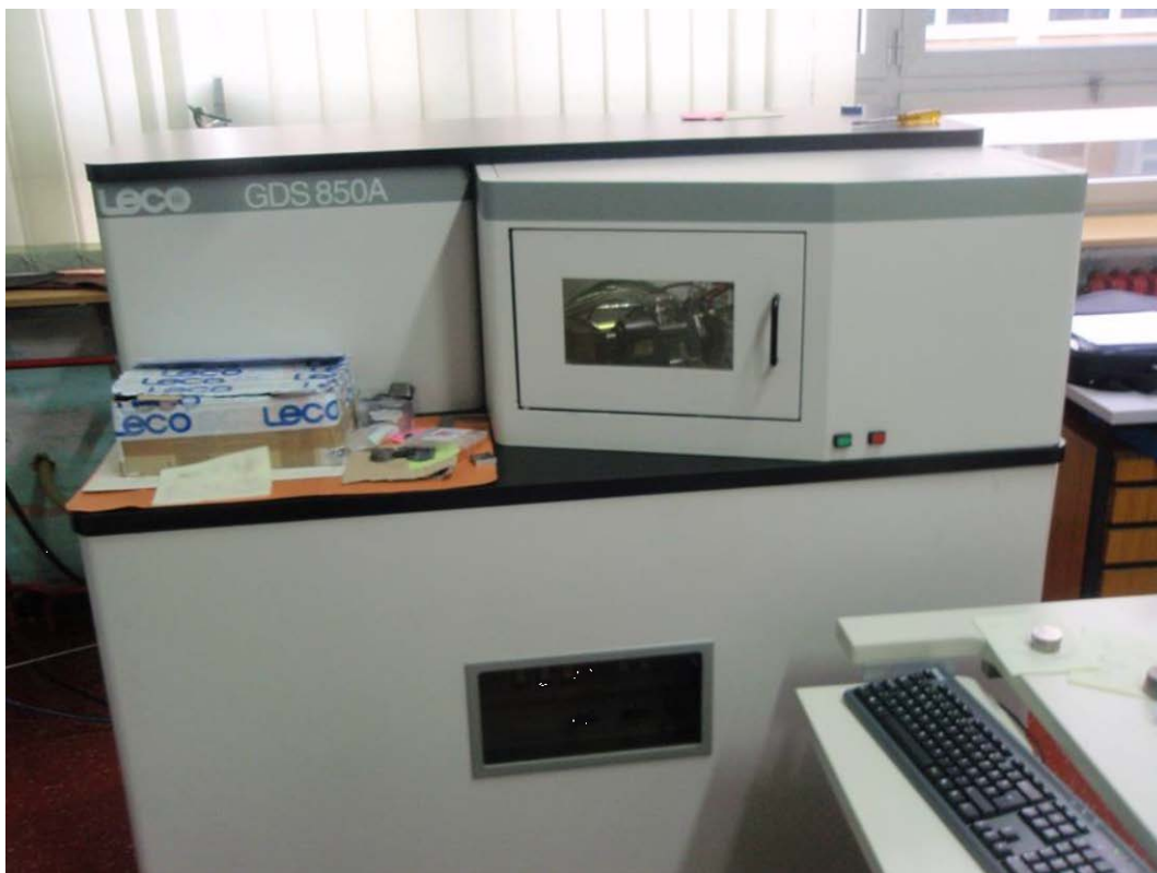
Slika 27. Uređaj za optičku emisijsku spektroskopiju s tinjajućim izbojem Leco GDS 850A [12]
