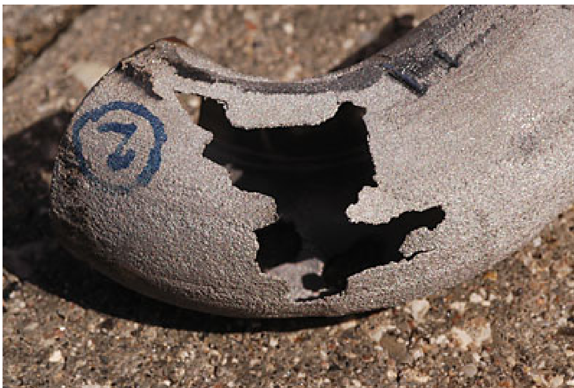
Slika 16. Interkristalna korozija koljena od čelika X5CrNi18-10 nakon nepravilne toplinske obrade [20]
