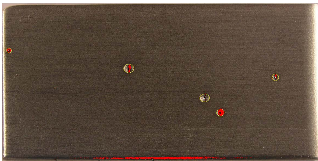
Slika 46. Izgled uzorka prilikom računanja površine u programu "ImageJ"
