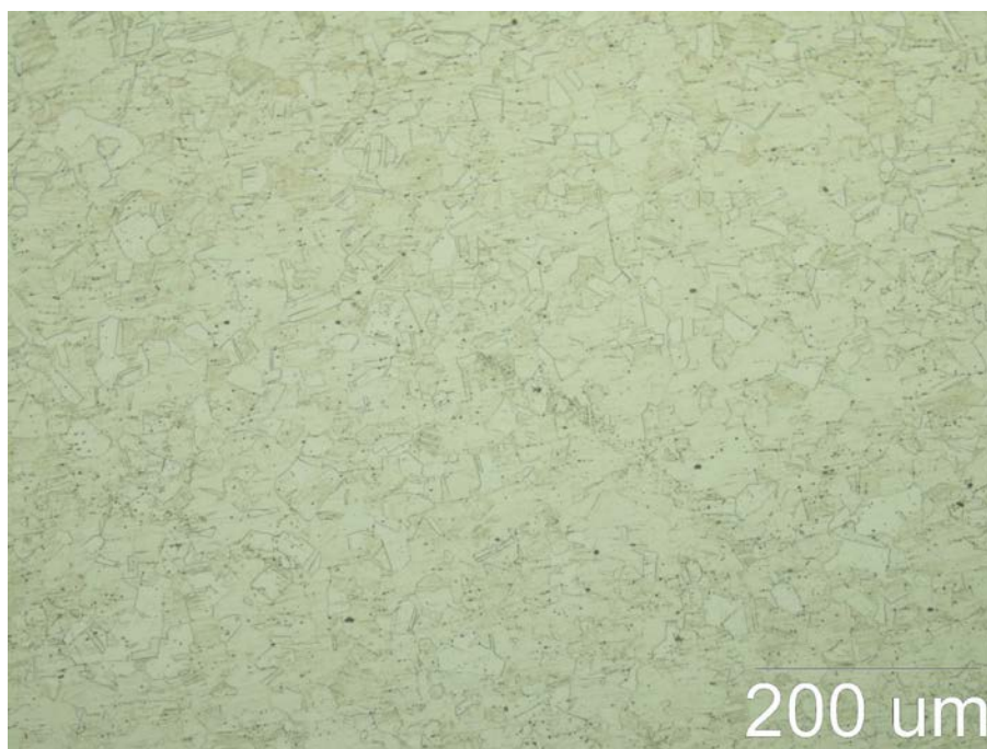
Slika 37. Mikrostruktura čelika X2CrNiMo17-12-2
