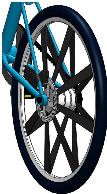
Slika 56. Planetarni prijenosni mehanizam
