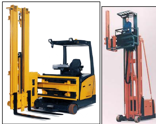
Slika 14. Viličar sa zakretnom vilicom
