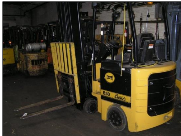
Slika 16. Viličar sa zakretnim jarbolom
