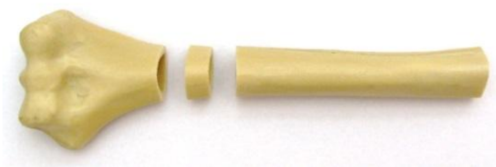
Slika 26. Umjetni osteoporotični distalni humerus – stanje po osteotomiji
