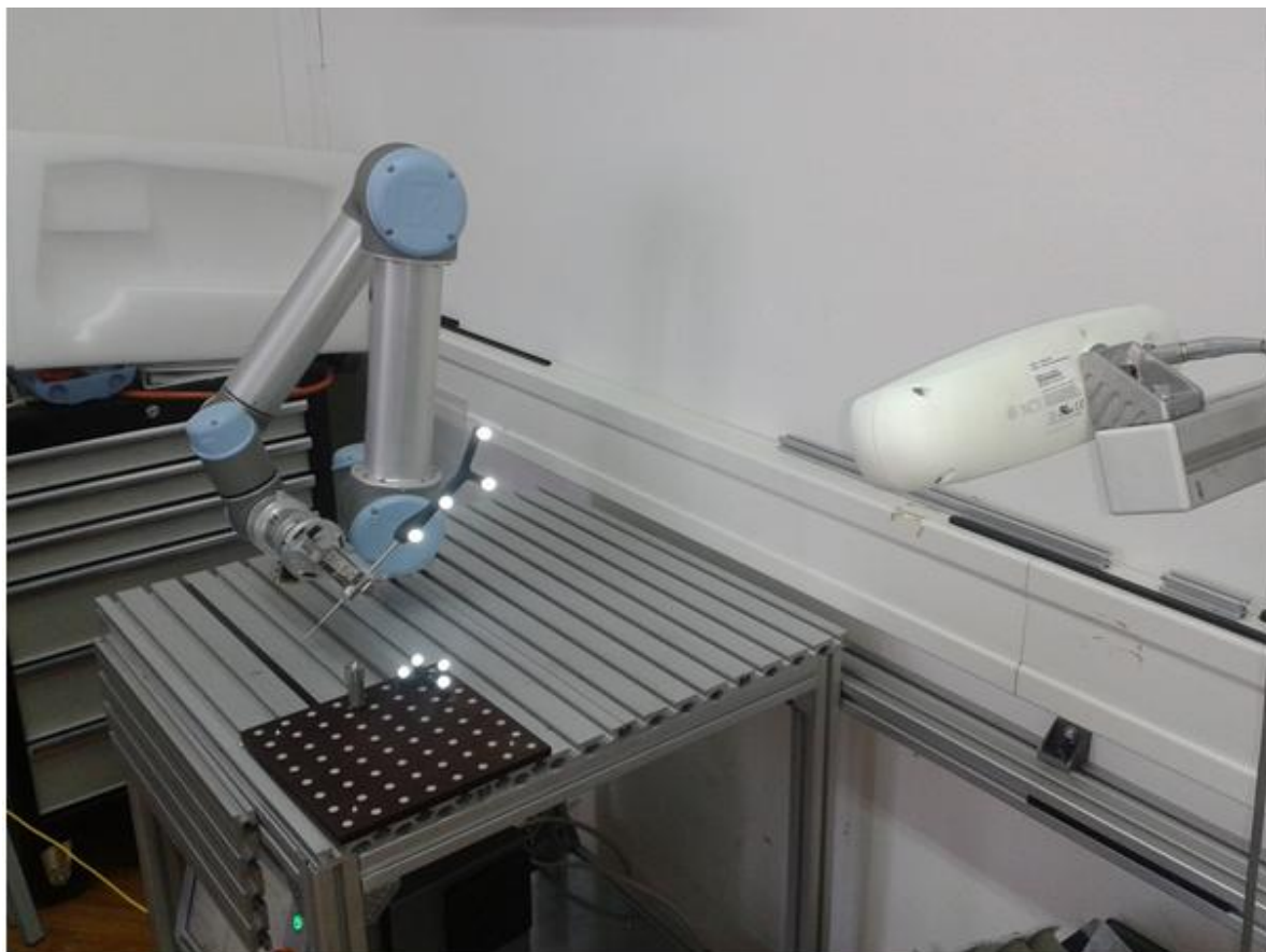
Slika 24. Markeri sa reflektirajućim sfernim kuglama
