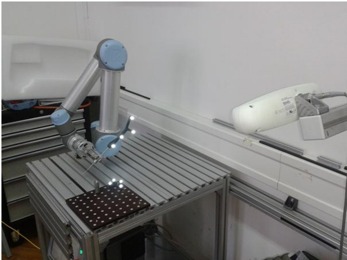
Slika 24. Markeri sa reflektirajućim sfernim kuglama
