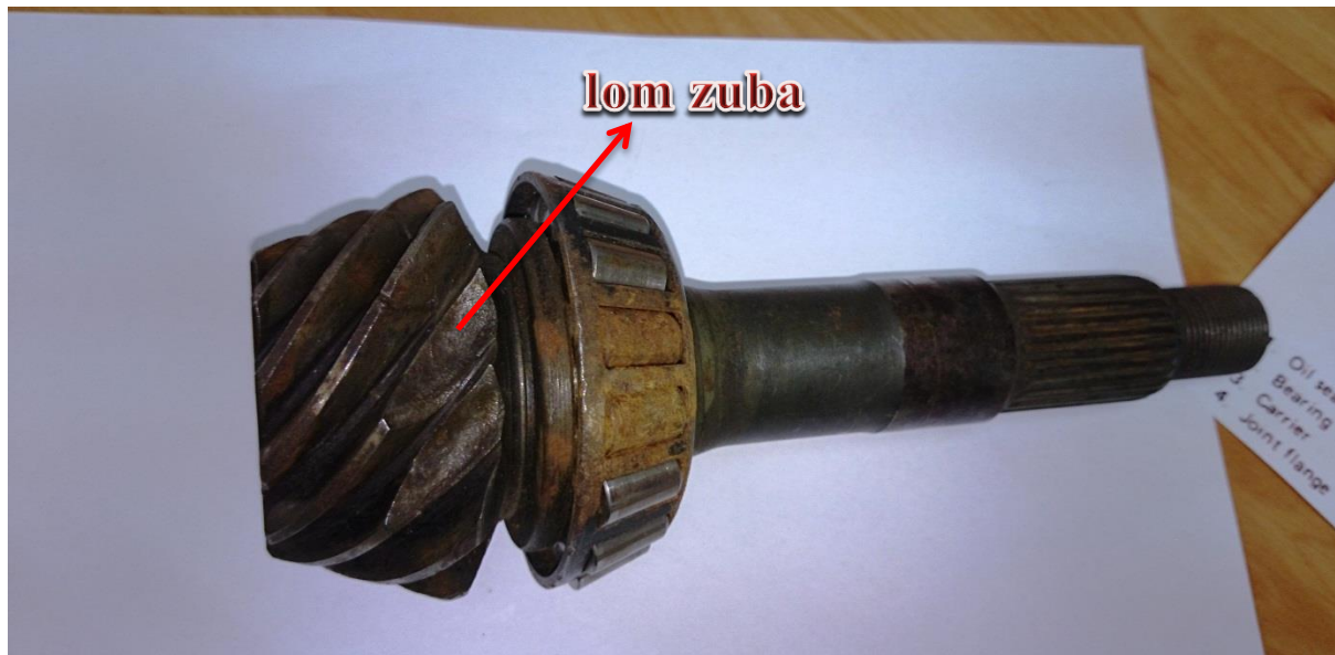
Slika 38. Lom zuba zupčanika stražnjeg diferencijala
