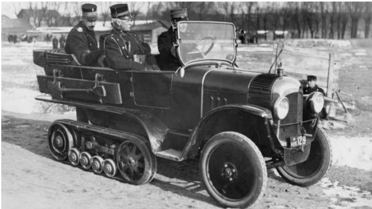
Slika 5. Prvi komercijalni model Kégresse track [2]
