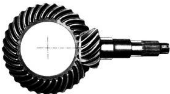
Slika 24. Stožnici sa zakrivljenim zubima [21]
