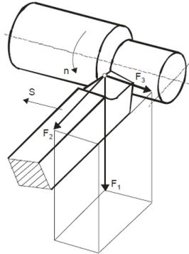
Slika 34. Komponente sile rezanja kod uzdužnog tokarenja
