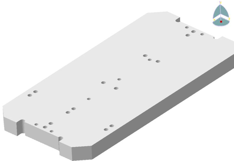
**Slika 55.** Pripremak drugog stezanja ploče NG01
