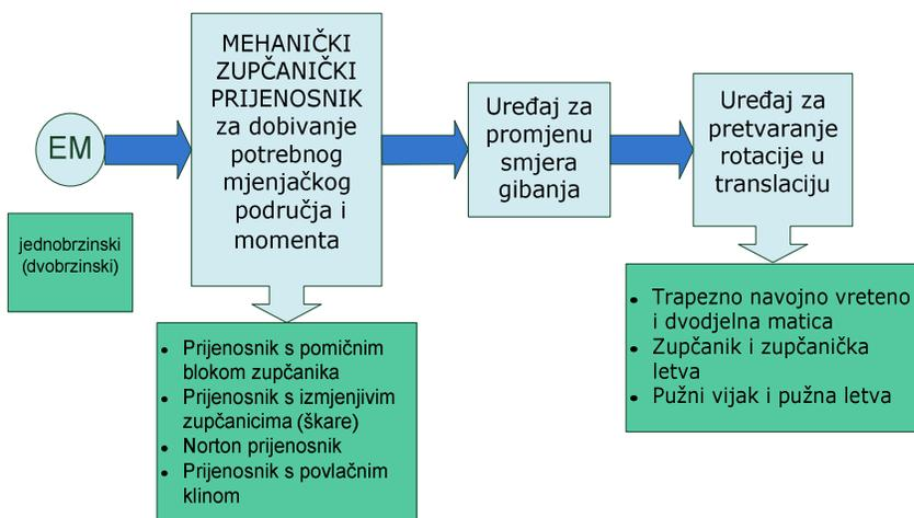
Slika 11. Posmični prigoni kod klasičnih alatnih strojeva
