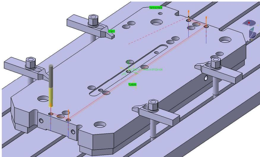
Slika 60. Putanja predbušenja svrdlom promjera 14 mm
