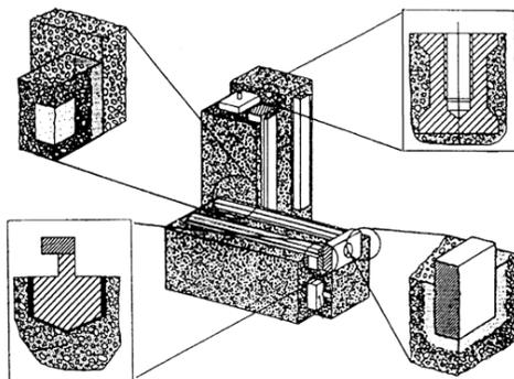
Slika 21. Postolja od mineralnog lijeva [6]
