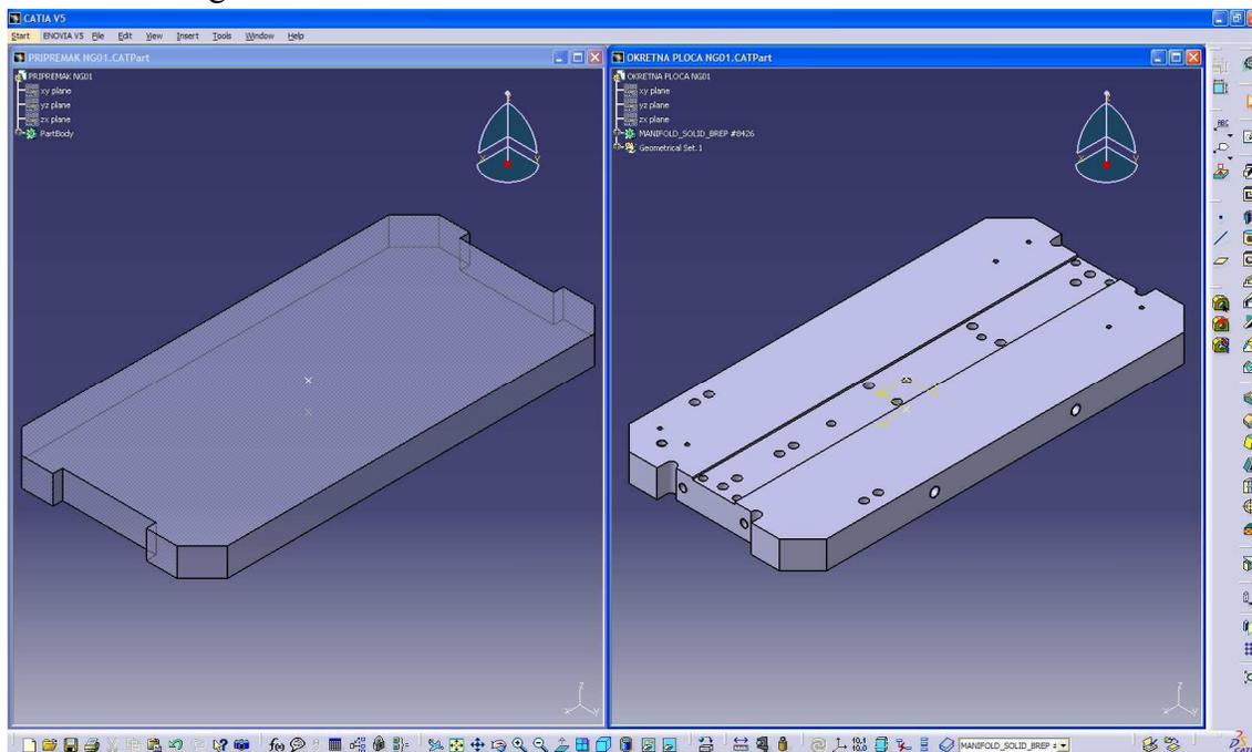
Slika 47. Pripremak i izradak okretne ploče NG01
