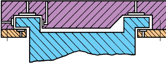
Slika 25. Klizne hidrostatske vodilice [6]
