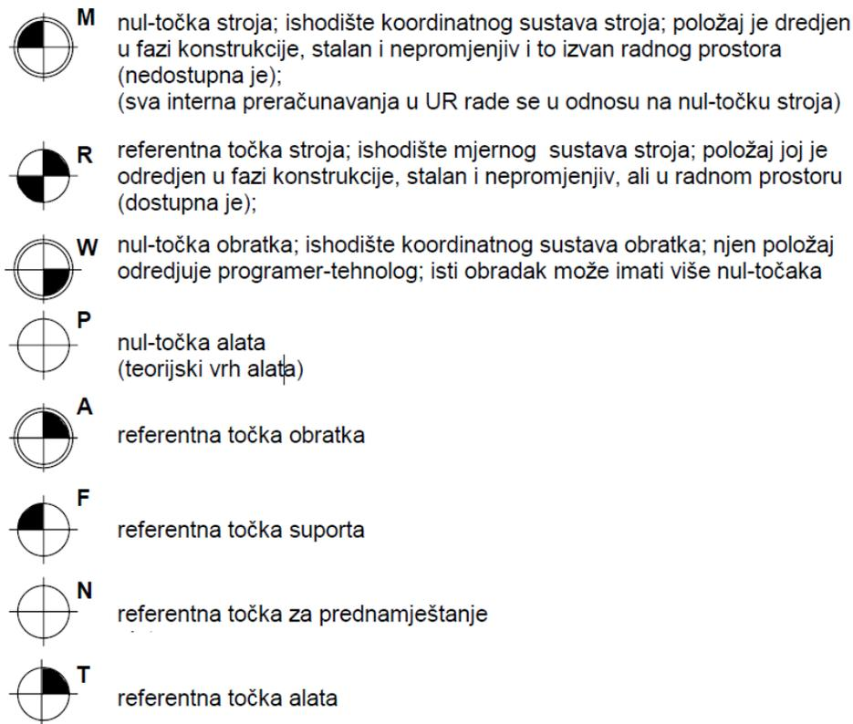
Slika 44. Nul - točke kod NC strojeva [17]
