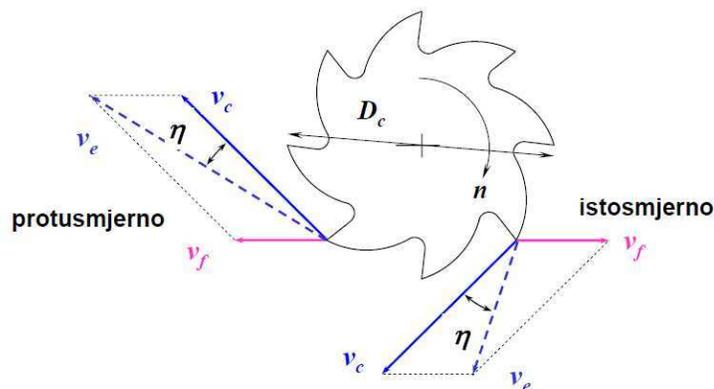
Slika 39. Brzine kod protusmjernog i istosmjernog glodanja [9]
