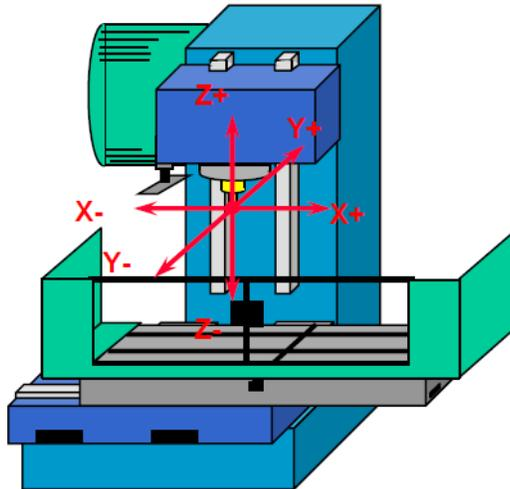
Slika 43. Položaj osi kod vertikalnog obradnog centra [17]
