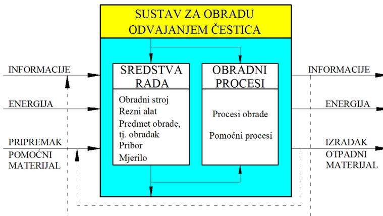
Slika 2. Shema sustava za obradu odvajanjem čestica
