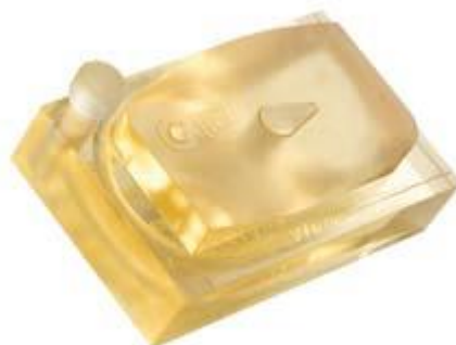
Slika 3.6. Proizvod od materijala FullCure 720 [20]
