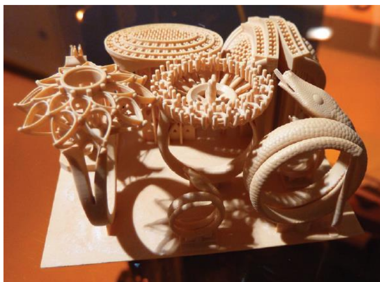
Slika 2.7. Nakit komplicirane geometrije proizveden postupkom očvršćivanja digitalno obrađenim svjetlosnim signalom [1]
