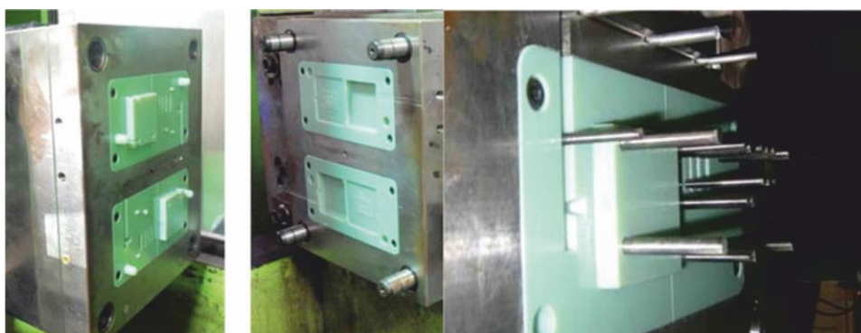
Slika 3.8. Kalupni umetci od materijala PolyJet GreenFire [8]
