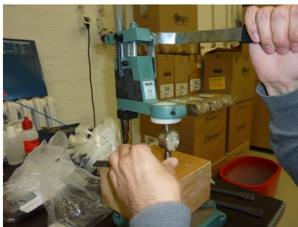
Slika 4.4. Mjerenje tvrdoće ispitnog tijela
