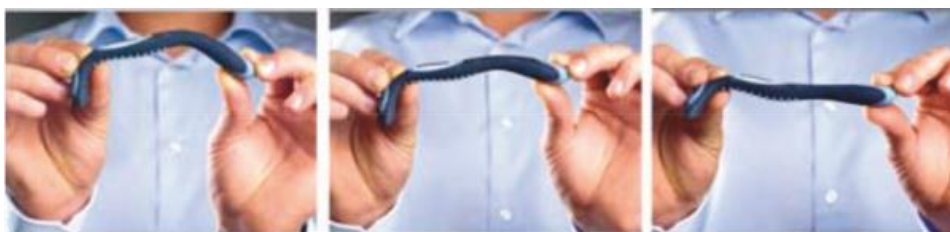
Slika 3.15. Isprobavanje krutosti držača britvica [15]
