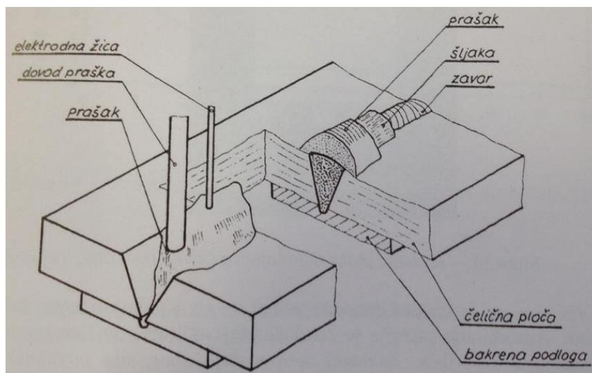
Slika 15. EPP postupak zavarivanja [8]
