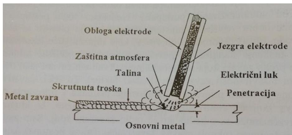
Slika 13. REL postupak zavarivanja [8]
