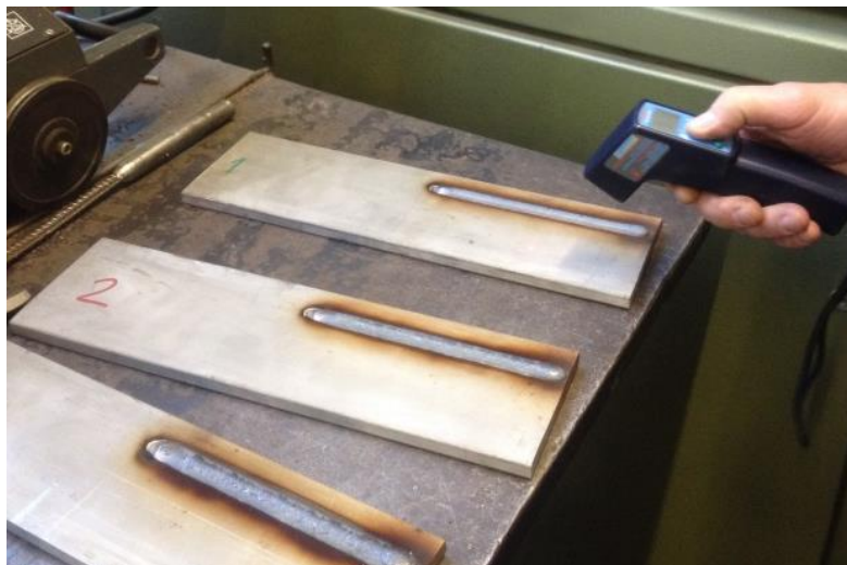
Slika 30. Mjerenje međuprolazne temperature
