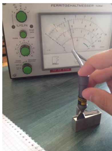
Slika 49. Mjerenje feritnog broja
