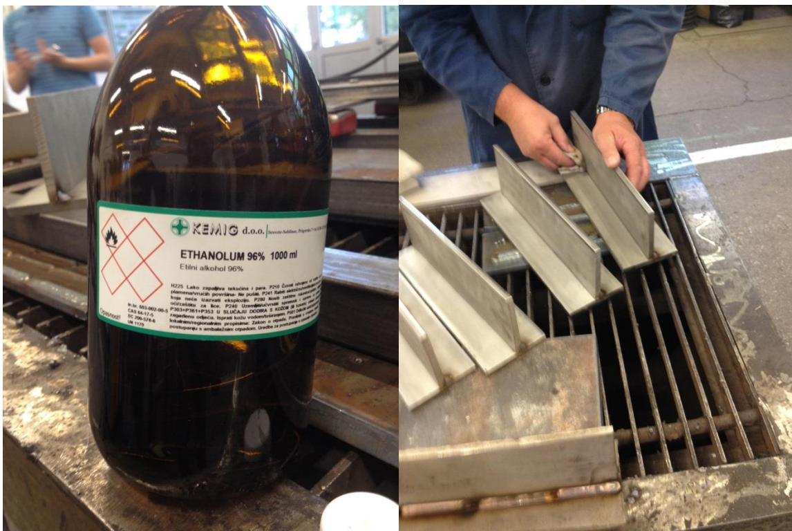
Slika 25. Čišćenje i odmašćivanje uzorka
