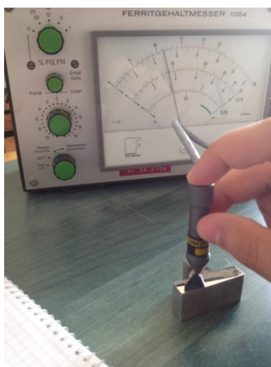
Slika 49. Mjerenje feritnog broja
