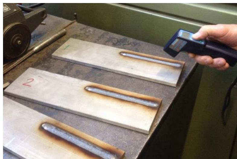
Slika 30. Mjerenje međuprolazne temperature
