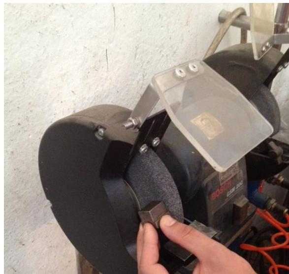
Slika 43. Grubo brušenje uzorka
