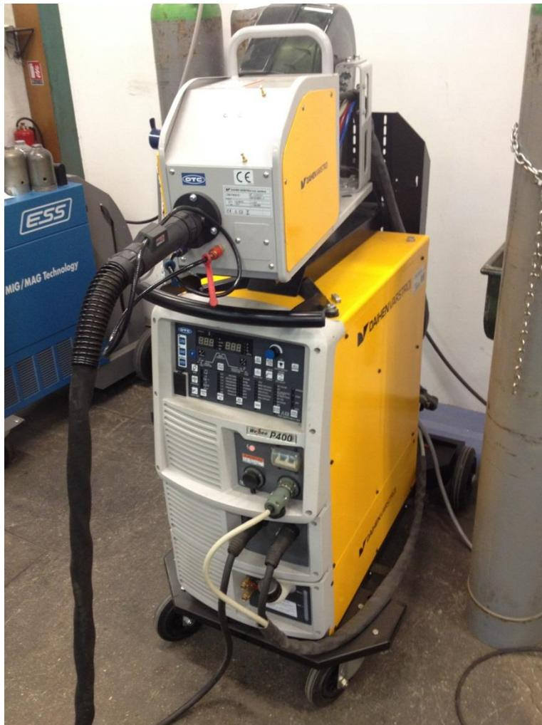
Slika 23. Uređaj za zavarivanje Varstroj WB-P400 (w)
