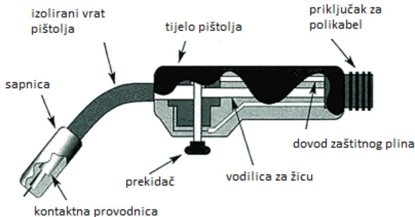
Slika 11. Dijelovi pištolja [15]
