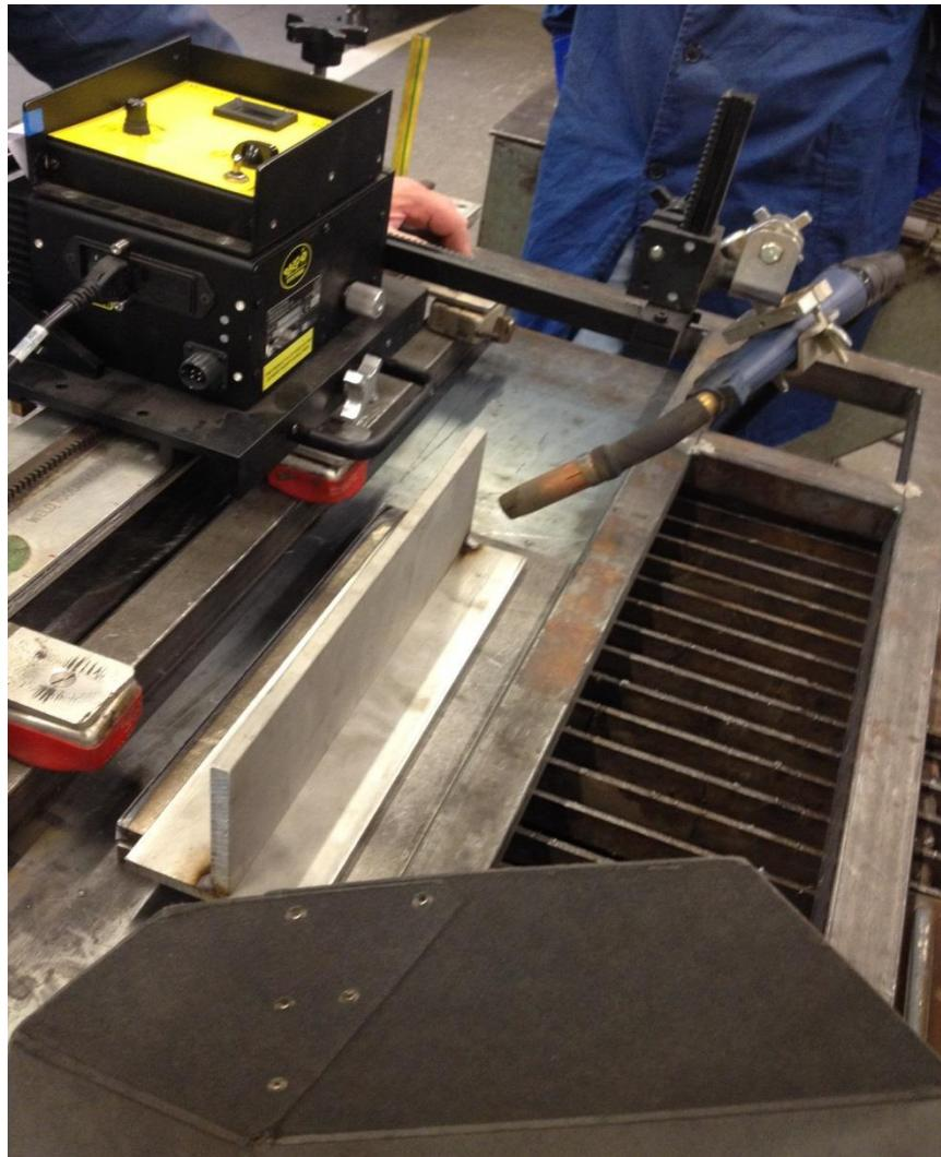
Slika 31. Prikaz postava eksperimentalnog rada za zavarivanje
