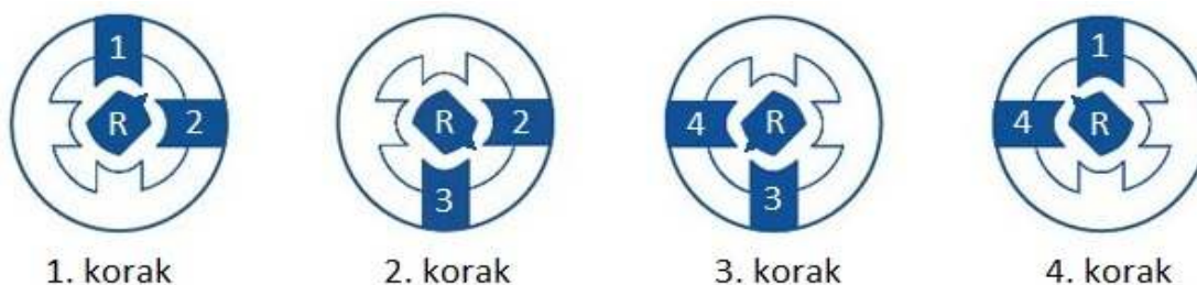
Slika 15. Režim rada motora aktivacijom dviju faza
