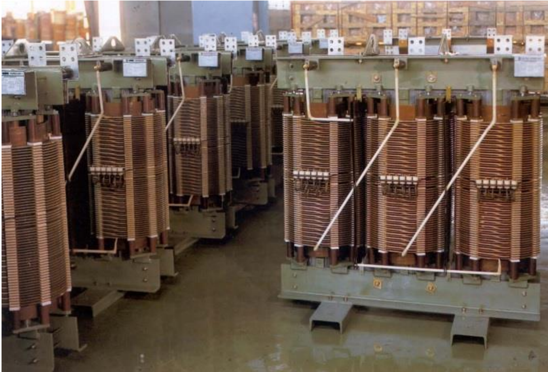
Slika 13. Primjer suhog distributivnog transformatora. [22]
