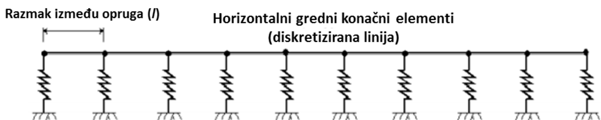
Slika 14. Diskretizirani pristup proračuna grede na elastičnoj podlozi [38]
