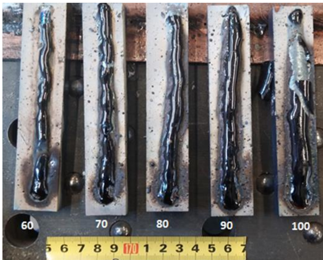
Slika 20. Epruvete nakon zavarivanja - Castoline DC(+)
