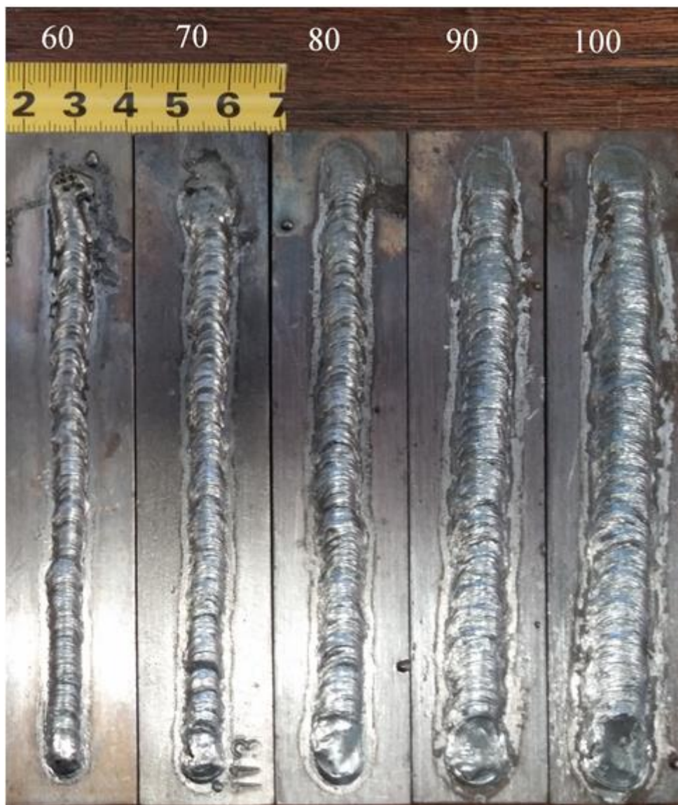
Slika 24. Epruvete nakon čišćenja - Castoline AC
