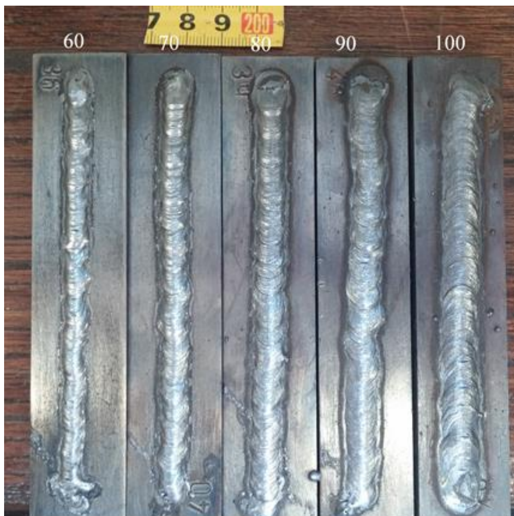
Slika 27. Epruvete nakon čišćenja - BÖHLER FOX EV 50
