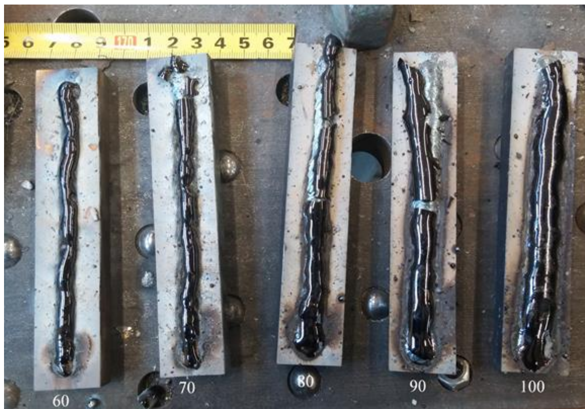
Slika 23. Epruvete nakon zavarivanja - Castoline AC
