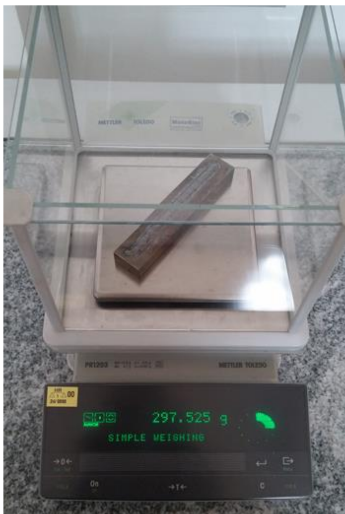
Slika 18. Primjer vaganja epruveta
