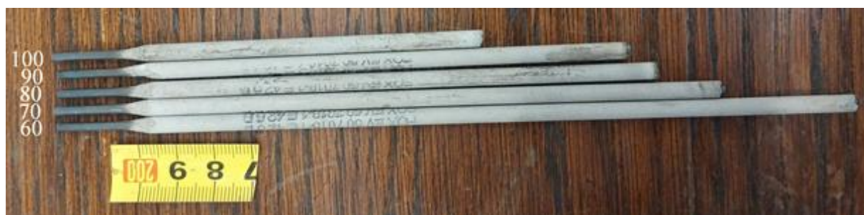
Slika 28. Ostatci BÖHLER FOX EV 50 elektrode nakon zavarivanja
