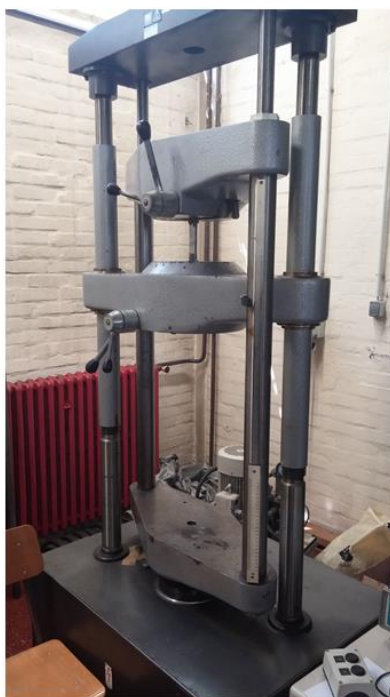
Slika 43. Statička kidalica WPM EU40mod
