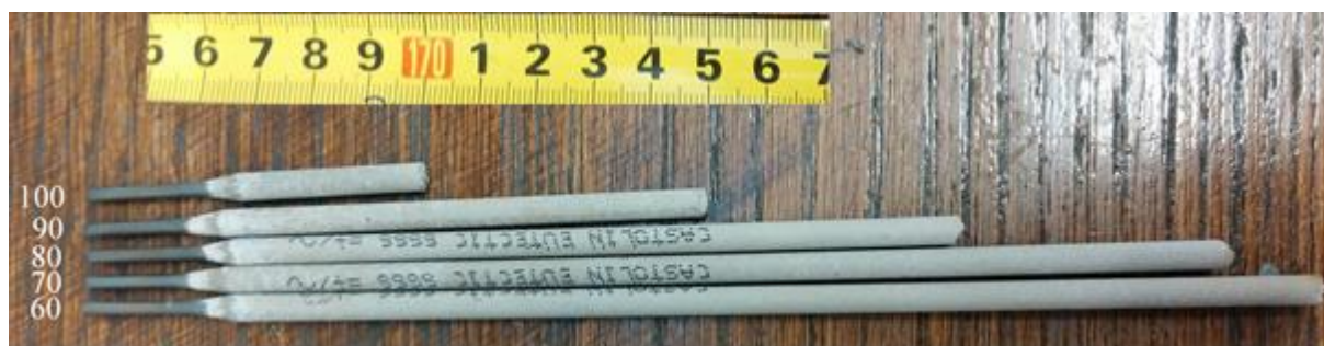
Slika 25. Ostatci Castoline-ovih elektroda nakon zavarivanja izmjeničnom strujom
