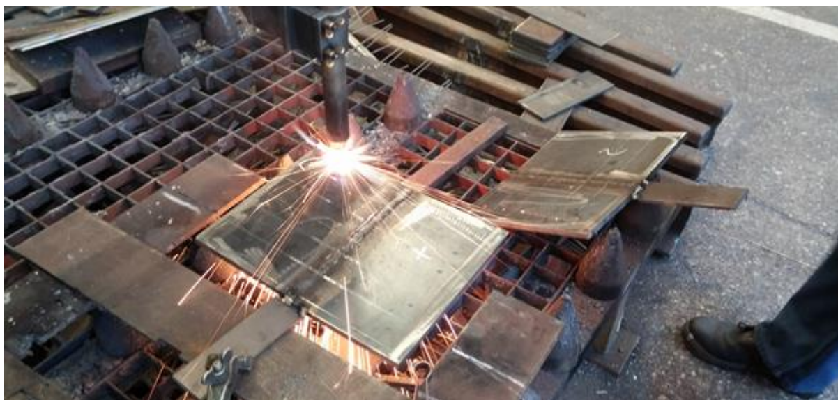
Slika 35. Plinsko izrezivanje epruveta
