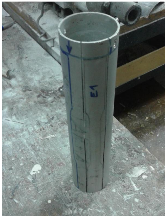
Slika 28. Cijev jarbola s označenim epruvetama za izrezivanje
