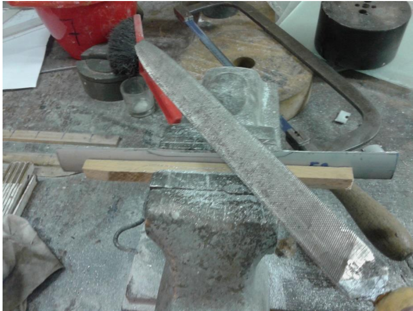
Slika 29. Prikaz turpijanja viška materijala i formiranja ispitne duljine
