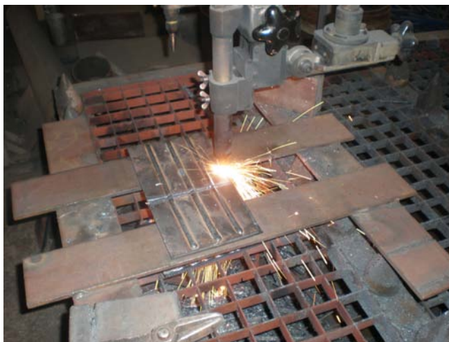
Slika 4.15 Rezanje ploče s navarima plinskim postupkom na automatskoj rezačici „Uljanik“
