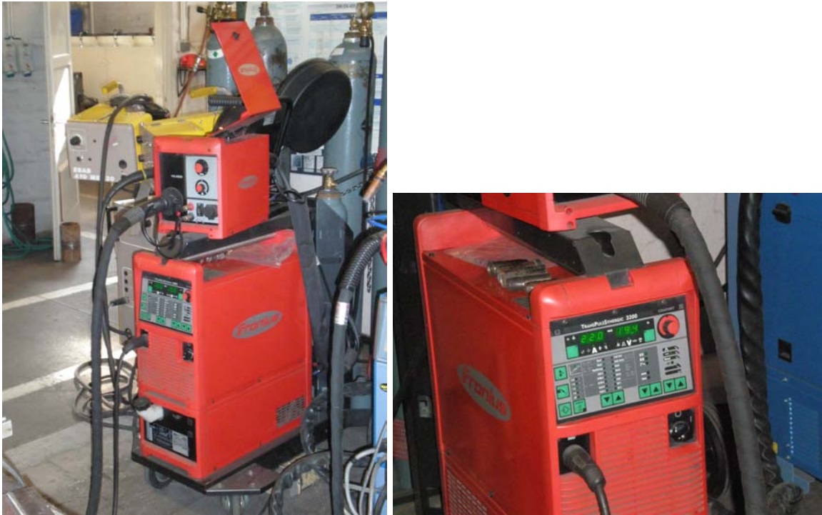
Slika 4.1 „Fronius TransPulse Synergic“ uređaj za zavarivanje
