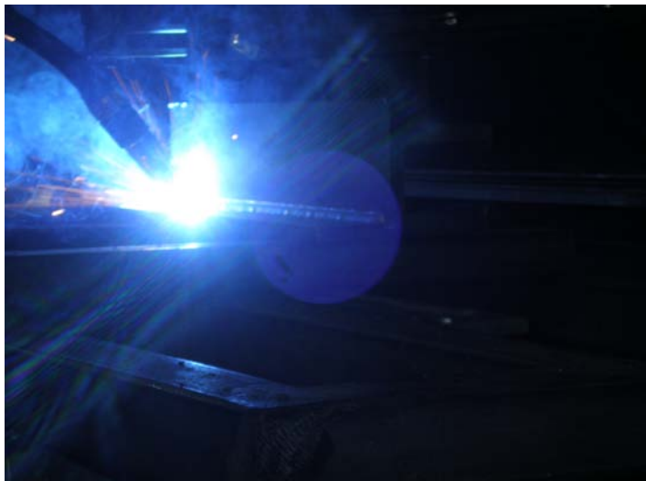
Slika 4.9 Zavarivanje kutnih uzoraka uz prijenos metala kratkim spojevima
